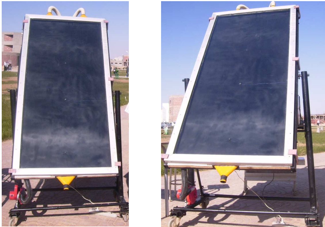
Fig(II-3) : capteur solaire plan à air exposé au soleil (photo dgm.Univ de Biskra 2007)
