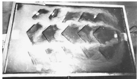
Fig. [II-6] : Visualisation de l'écoulement d'un jet de fumée dans un capteur en présence de chicanes triangulaires
