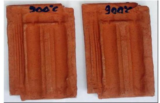
Fig. 4.11. Echantillons de brique et de tuile fabriqués avec la vase de SMBA.
