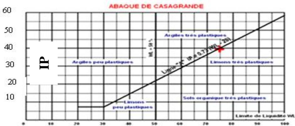
Fig.4.6. Limites d'Atterberg des sédiments du centre de la retenue
