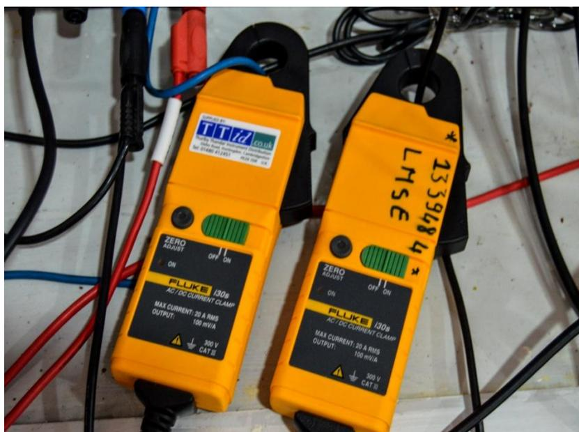
Figure 3 Capteur de courant.
