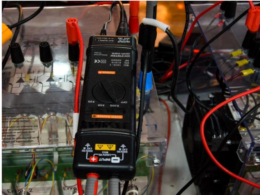
Figure 4 Capteur de tension.
