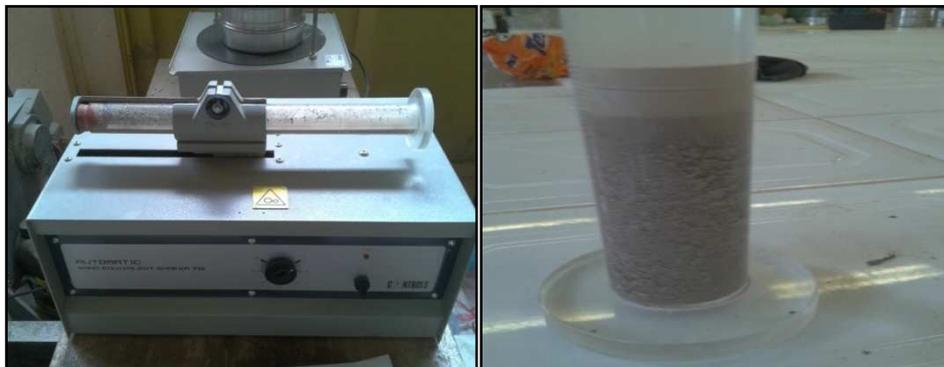
**Photo III.12 :** Procédure de calcul de l'équivalent de sable
