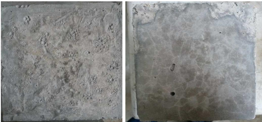
**Photo IV.1 :** Etat des éprouvettes après l'effet cyclique du gel/dégel
