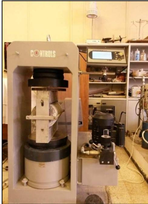
**Photo III.23 :** Machine et dispositif d'essai de traction par fendage
