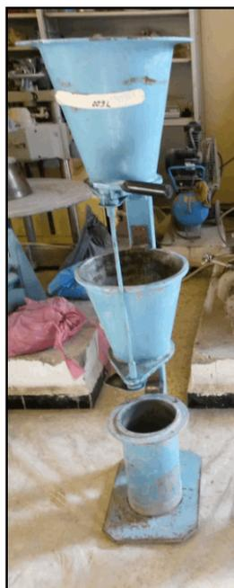
**Photo III.18** : Dispositif de mesure de la compacité des bétons
