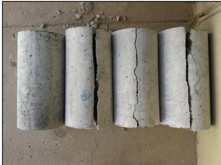
**Photo III.24 :** Eprouvettes cylindrique après écrasement
