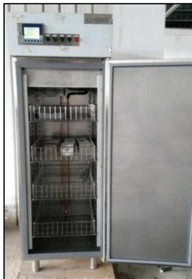
**Photo III.27 :** Enceinte climatique (conservation pour le cycle gel/dégel)
