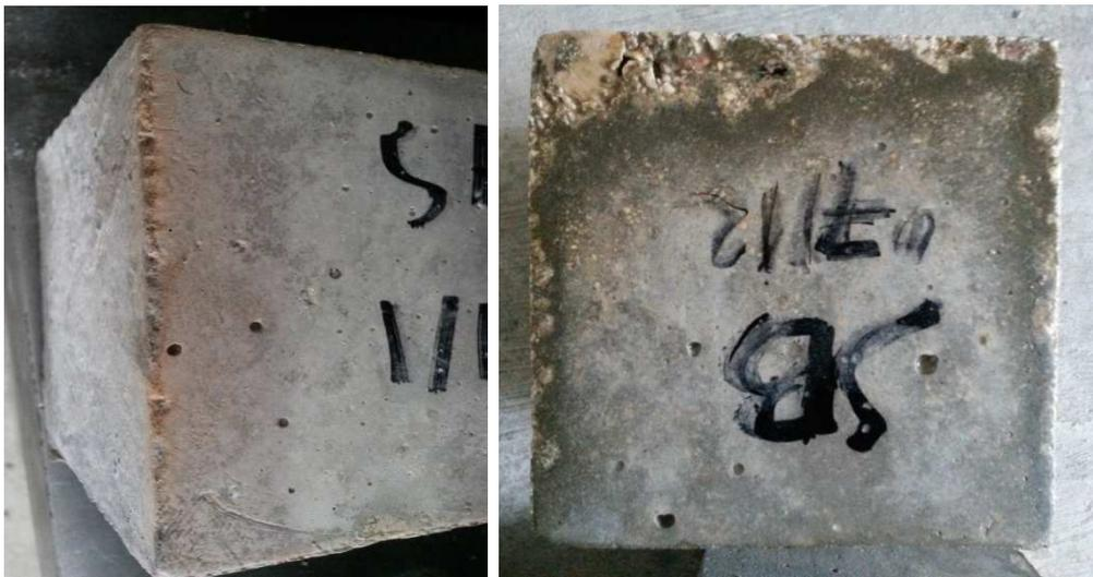
**Photo IV.3 :** Etat des éprouvettes après immersion dans Hcl
