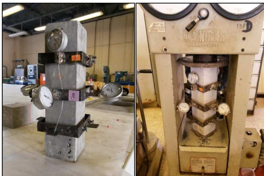
**Photos III.25** : Dispositif pour le calcul des déformations longitudinales et transversales (Laboratoire de GC de l'Université de Biskra 01/2015)
