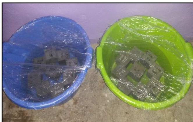
**Photos III.29 :** Conservation des éprouvettes exposées à des milieux agressifs (Laboratoire de GC de l'Université de Constantine 03/2015)
