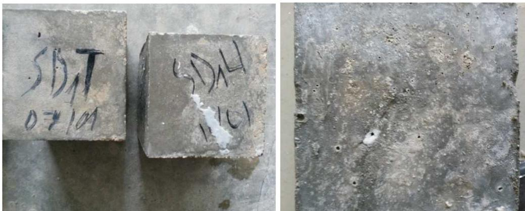
Photo IV.2 : Etat des éprouvettes après immersion dans  $\text{Na}_2\text{SO}_4$
