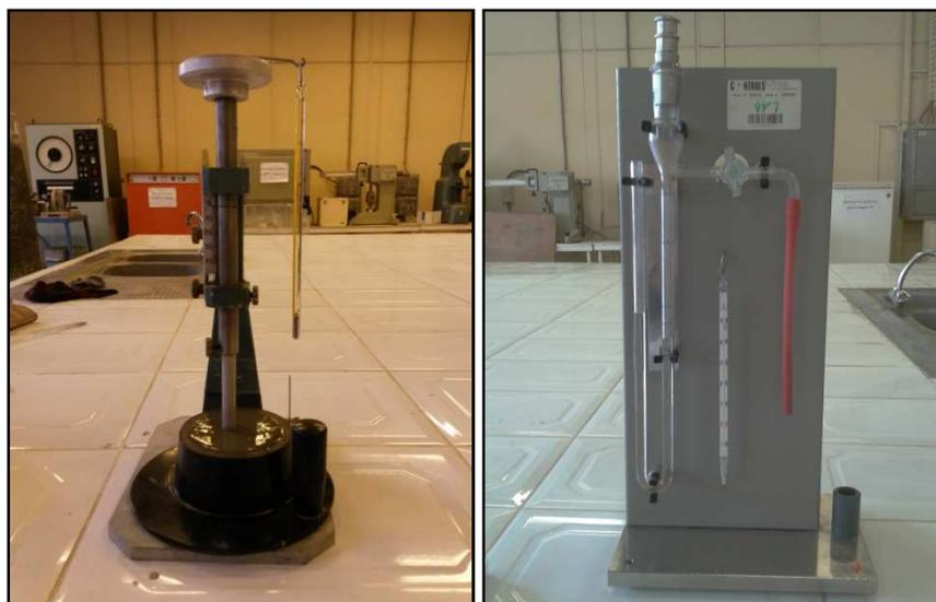
**Photo III.1 :** Différents dispositifs employés pour le calcul de la consistance, du temps de prise et de la finesse (Vicat à gauche, Blaine à droite)
