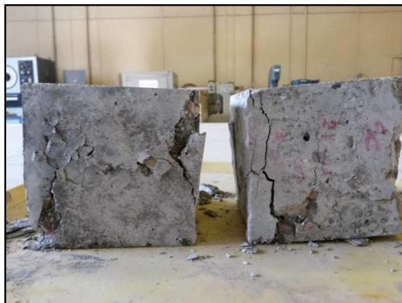
**Photo III.20 :** Eprouvettes cubiques (10x10x10) cm<sup>3</sup> après écrasement (Laboratoire de GC de l'Université de Biskra 02/2014)
