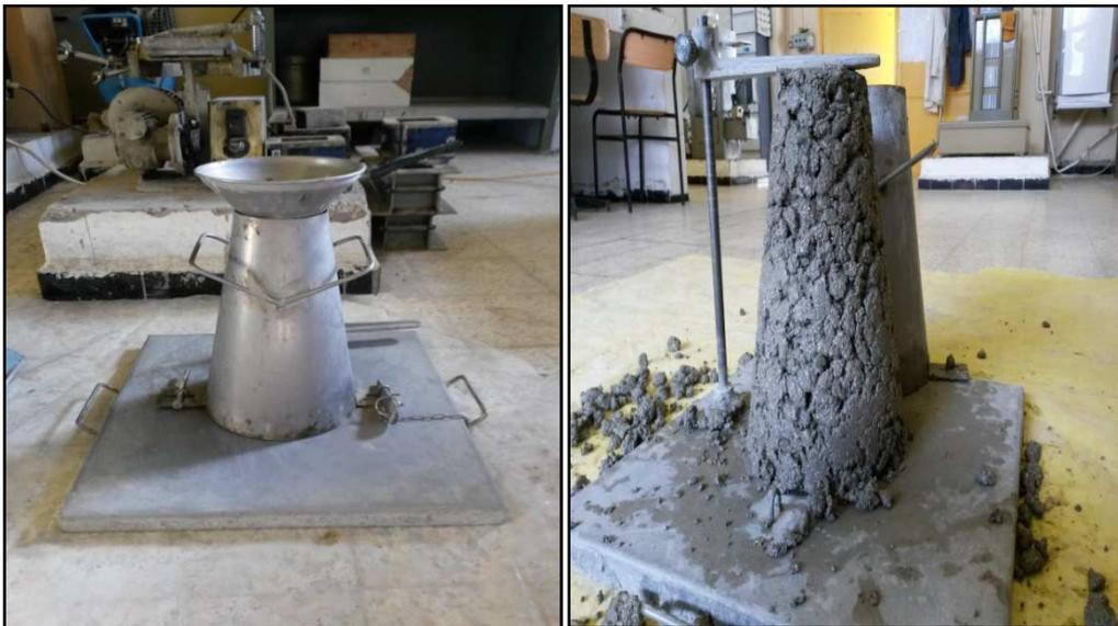
Photos III.16 : Essai réel d'affaissement au cône d'Abrams
