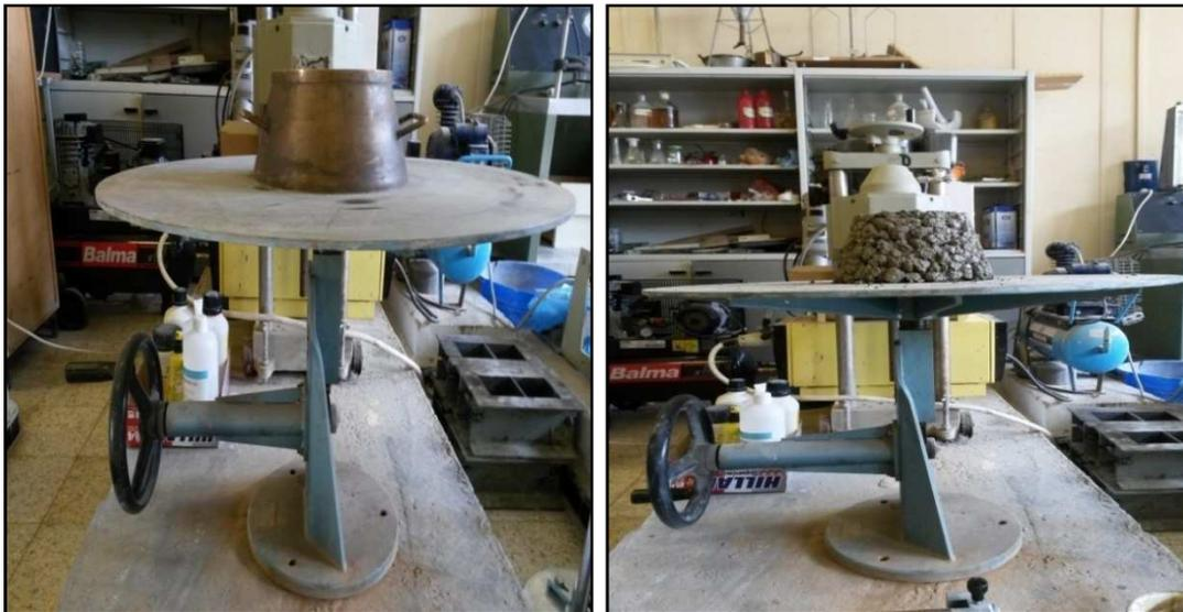
**Photos III.17 :** Table à secousses utilisée lors des essais (Laboratoire de GC de l'Université de Biskra 01/2014)
