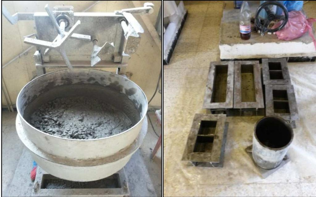
**Photos III.14 :** Malaxeur et moules utilisés pendant les essais
