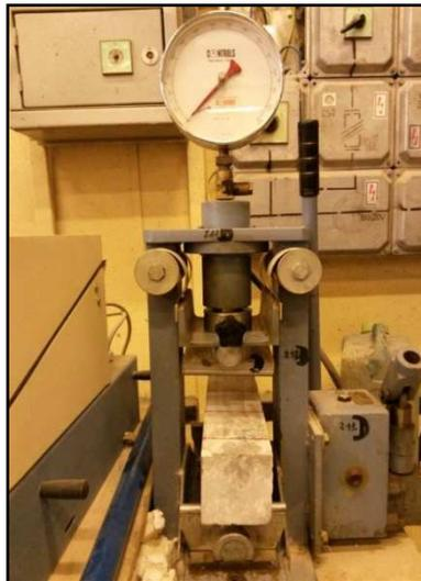
**Photo III.21** : Machine d'essai de flexion utilisé
