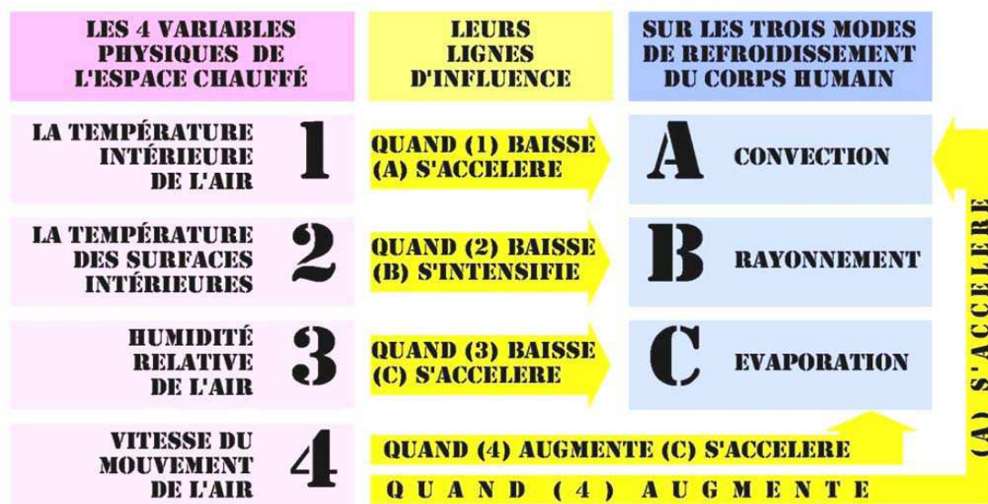
Figure 2.4. Relation entre les paramètres de confort et les modes d'échange de chaleur. Source : MAZARIM, 2012
