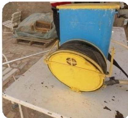
**Figure 56**: Poudreuse semi mécanique utilisé par certaines phoeniciculteurs de la région d'étude (Photo original)
