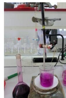
**Figure 36:** Méthode de dosage de calcaire actif. (Photo original)
