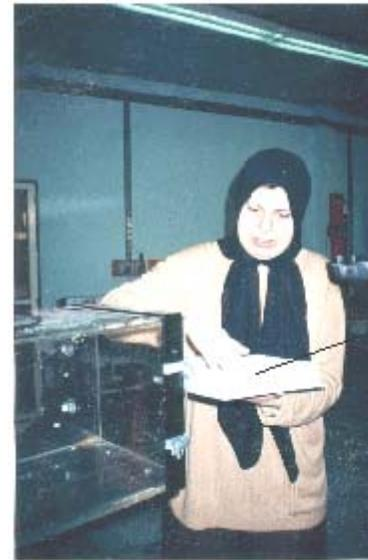
Préparation de la maquette en déposant un produit qui visualisera l'écoulement de l'air (Grains de Polystérene colorés
