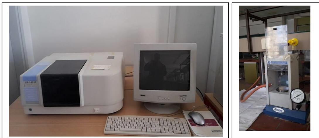
*Figure II.9 Fourier transform spectrometer (FTIR) Shimadzu 8400S.*
