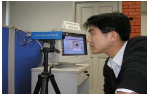
**Figure 4.1** L'appareil développé par CASIA pour la collection de la base de données CASIA-IrisV1 [87].
