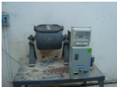
**Fig. 2.8 :** Broyeur à boulet
