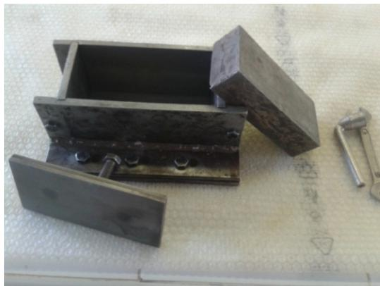
**Fig. 2.14 :** Moule utilisé pour la fabrication des BTC
