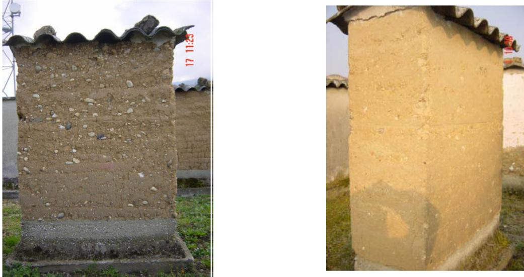
**Fig. 1.30** : Effet de la stabilisation à la chaux sur deux murs en pisé (à gauche : pisé stabilisé, à droite pisé non stabilisé) Bui (2008).
