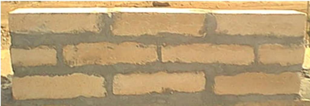
**Fig. 1.29 :** Muret avec des briques stabilisées par 12 % de la chaux après 48 mois d'exposition aux conditions naturelles. Guettala (2003)
