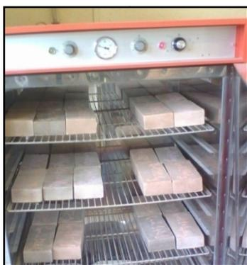
**Fig. 2.23 :** Eprouvette séchée dans l'étuve.
