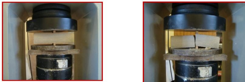
**Fig. 2.18 :** Essai de traction par fendage
