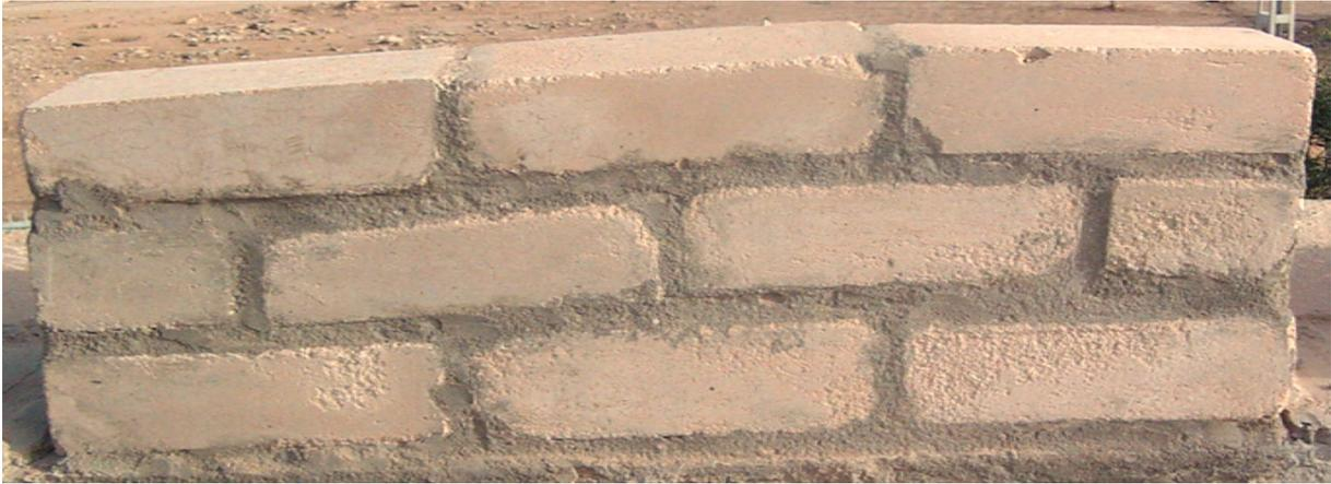
**Fig. 1.28 :** Muret avec des briques stabilisées par 8 % de la chaux après 48 mois d'exposition aux conditions naturelles. (Guettala, 2003)
