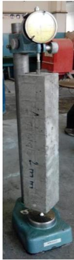
Fig.1.II.2 : Mesure d'un prisme de béton.
