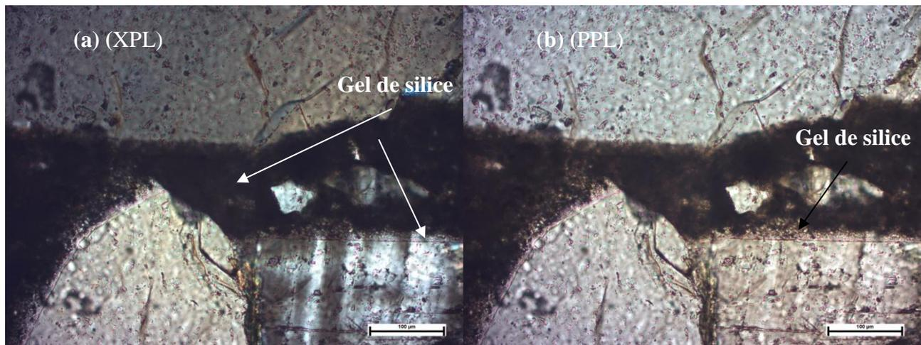
Fig.3.VIII.19: Imagerie d'une section mince de la barre de mortier tester altéré à une amplification de 200x fois avec polarisation croisée (XPL) en (a) et polarisation plane (PPL) en (b)
