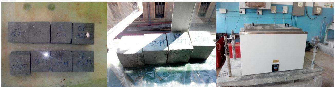
Fig.3.VII.1 : (a) Stockage pour 28 jours à  $23 \pm 2 \text{ C}^\circ$ . (b) Stockage pour 28 jours à température et HR ambiante. (c) Stockage pour 28 jours à  $80 \pm 2 \text{ C}^\circ$  et  $60 \pm 2 \text{ C}^\circ$ .
