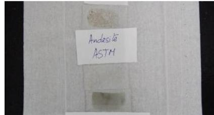
Fig.3.VIII.16: Section mince du barre de mortier à base de andésite (ASTM).
