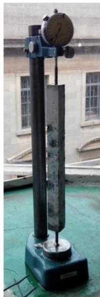
Fig.3.III.2: Support de mesure d'élongation
