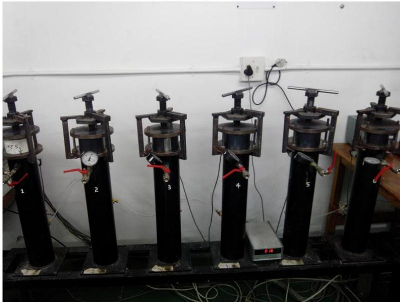
Fig.3.VII.3 : (a) Equipement pour mesuré la perméabilité.
