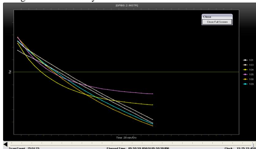
Fig.3.VII.4 : Enregistrements de la chute de pression de l'oxygène pendant l'essai de perméabilité.
