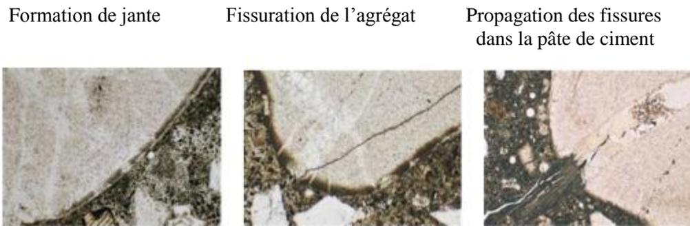
Fig.4.VIII.1: Fissure à l'intérieur de la nucléation des granulats suivi par la propagation à l'intérieur de la pâte de ciment [Katayama.2012]
