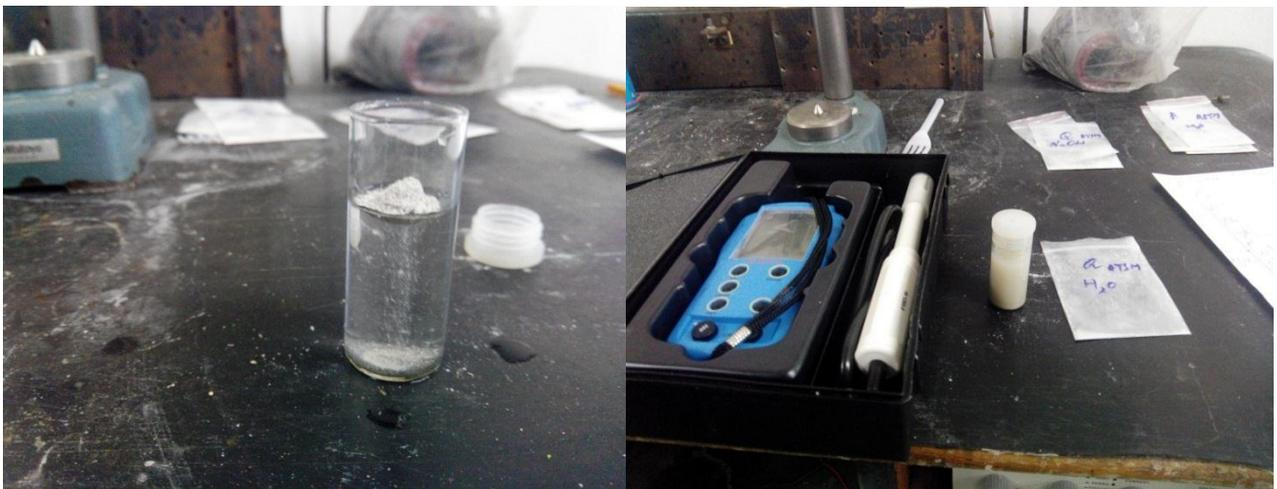
Fig.3.VII.13 : Le pH d'un échantillon de poudre de béton obtenu après 60 secondes de ponçage de surface en utilisant du papier de verre relevée par un pH-mètre.
