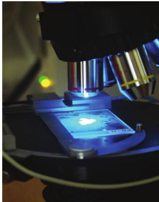
Fig.2.IV.2 : Une section mince de béton sous un microscope polarisant à éclairage UV.
