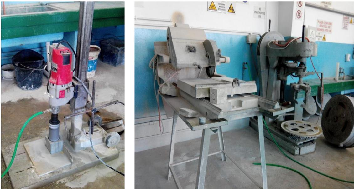
Fig.3.VII.2 : (a) Appareil à carottage. (b) Scie mécanique pour béton
