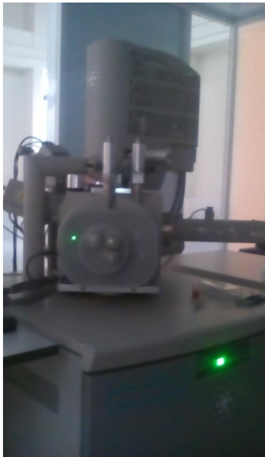
Figure II.8 : Microscope électronique à balayage ESEM-FEI Quanta 600 FEG
