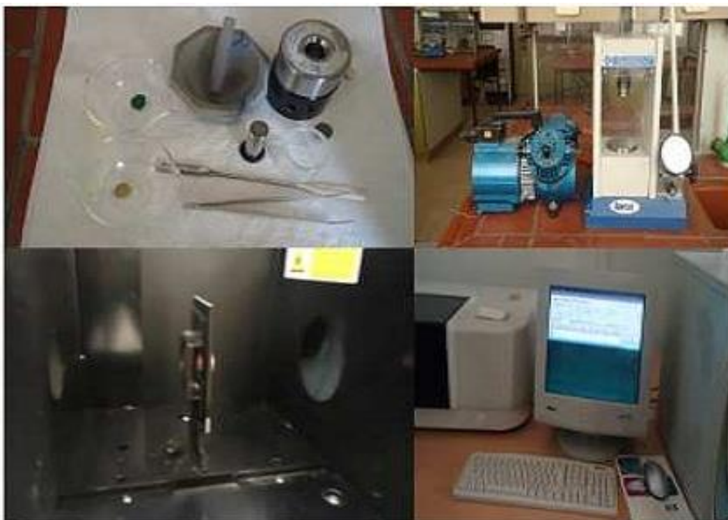
Figure II.2: spectromètre Infrarouge à transformée de Fourier FTIR-Shimadgu 8400S
