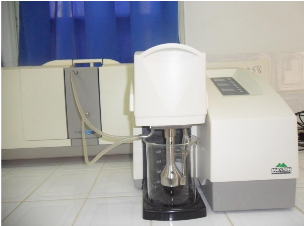
Figure II.12 : granulomètre laser Malvern Mastersizer 2000/3000.
