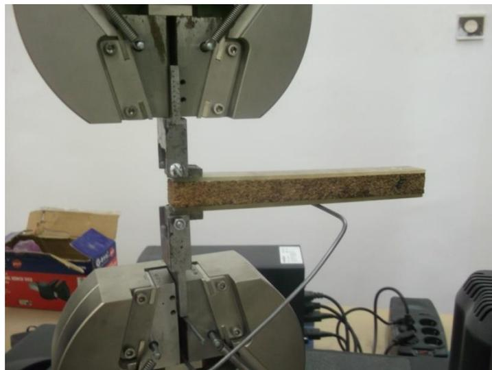
**Figure.III.52. Position du sandwich entre les deux mores de la machine**
