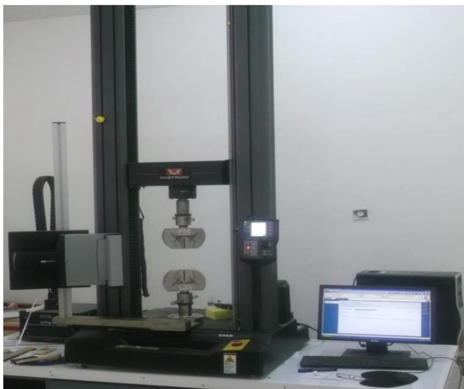
Figure III.15. Machine Universelle type INSTRON modèle 5969
