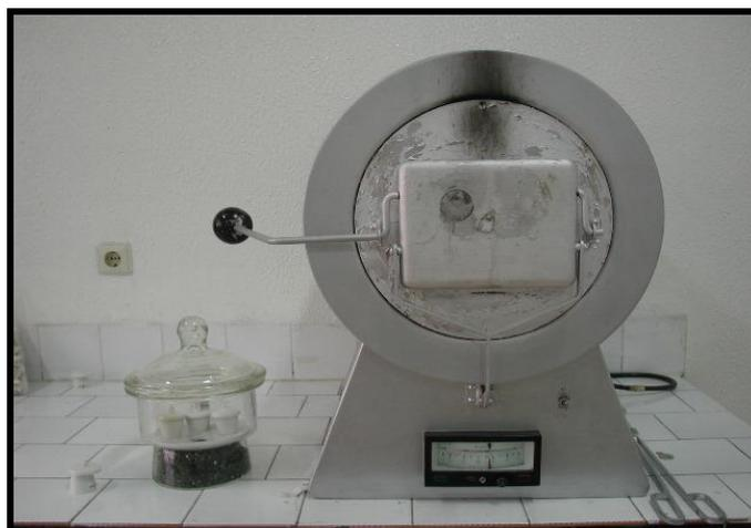
Figure III.11. Four et Dessicateur (la tare + sélicagel)
