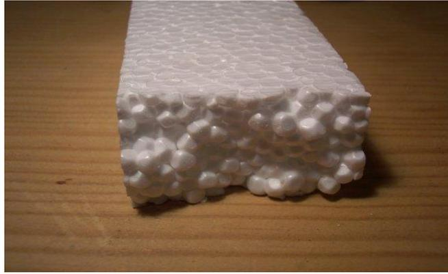
**Figure III.4. Polystyrène expansé**
