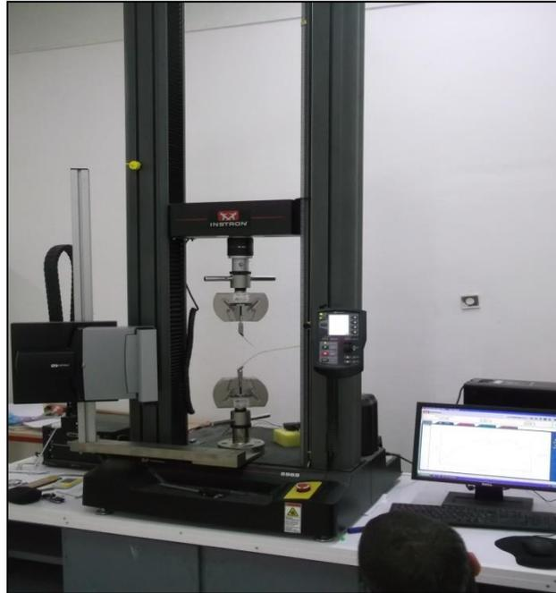
**Fig.III.42. Eprouvette (DPE) sur la machine universelle**
