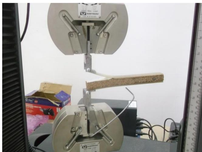
Figure.III.54. Essai du délaminage du sandwich
