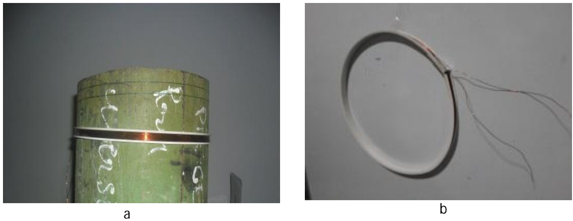
Fig.III.4 Description du problème, (a) Tube d'Acier avec capteur encerclant, (b) Le capteur encerclant
