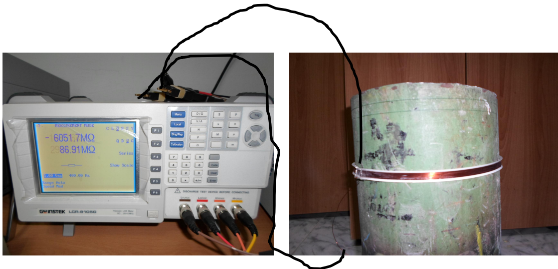
Fig.III.1 Mesure expérimentale de l'impédance du capteur par LCR 8105G
