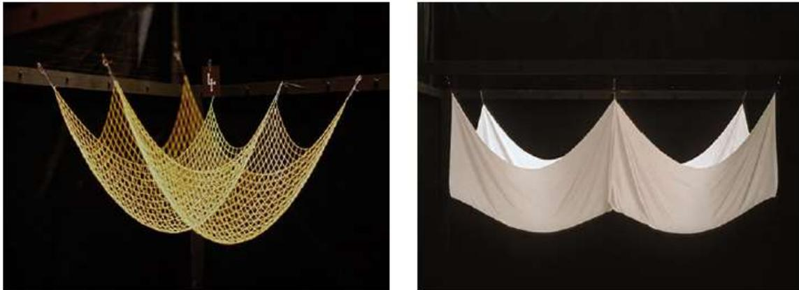
Fig. 2.2 modèle de la pendaison (Hanging model) Adriaenssens, Block et al. (2014)
