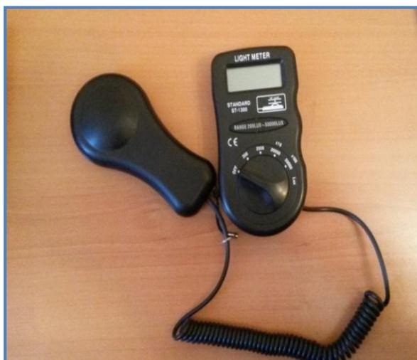
صورة رقم VI-26 : صورة جهاز لوكس متر:
