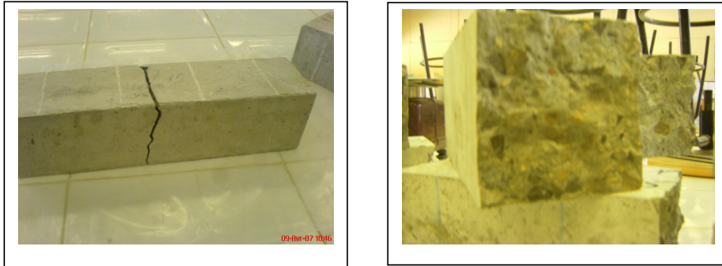
Photo 4-2 : rupture des éprouvettes « essais de flexion »
