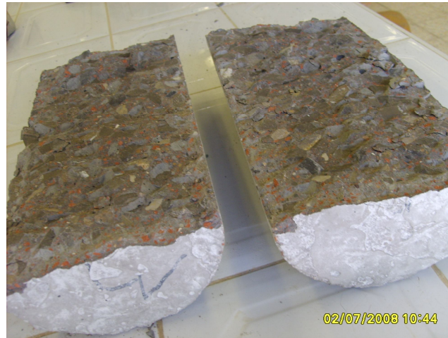
Photo 3.10: Ecrasement d'une éprouvette cylindrique (16 \times 32) \text{ cm}^2
