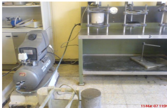
Photo 3-12 : Essai de perméabilité.
