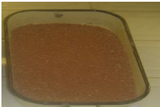
Photo 3-2 : Sable recyclé (SDBR) 0/5 produit par le concassage des déchets de briques
