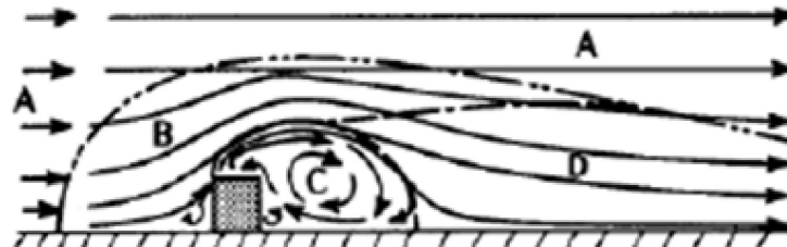
Figure 3.22: Les lignes de courant et les zones d'écoulement. A: vent non perturbé, B: la zone de déplacement, C: la zone de cavité ou zone de recirculation du vent, D: la zone de sillages d'après (Haistry 1963), adopté de (Kitous, 2012).
