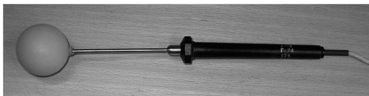
Figure 1.2 : Thermomètre 38 mm plat globe gris. (Thorsson et al, 2007).
