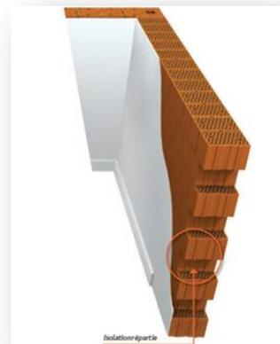
Figure 27: l'isolation répartie source <http://isolation.maison-materiaux.com/>
