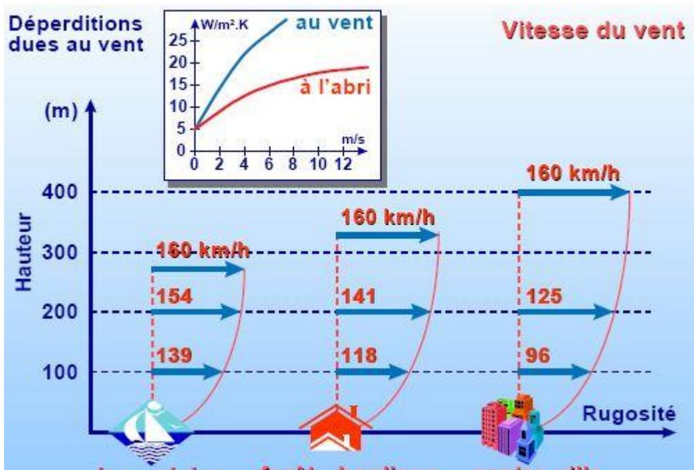
Figure 9: variation de la vitesse du vent par rapport à l'altitude et la nature du sol.
