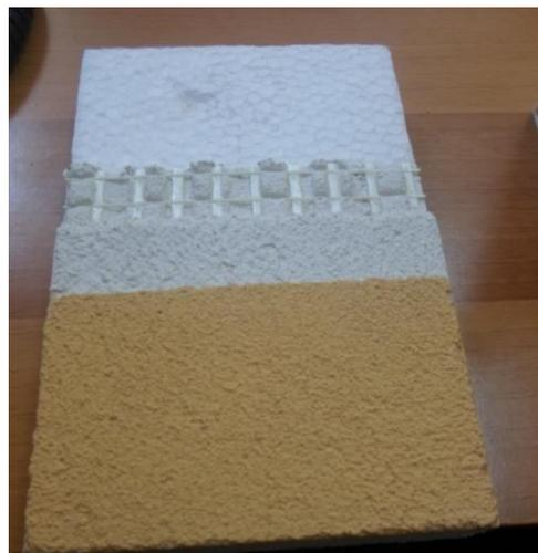
Figure 64: le polystyrène pour l'isolation extérieur.
