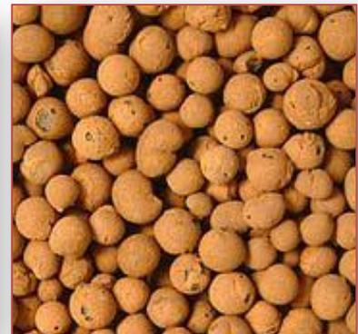
**Figure 32: l'argile expansée.**
