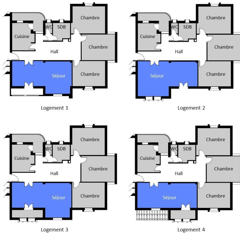
Figure 3–8: Plan des logements typiques de 50 P (Source : Auteur)
