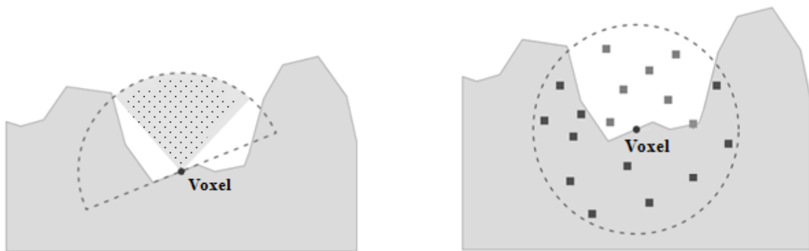
Figure 4—3 : Voisinage du voxel. Gauche: hémisphère détermine l'OA; la partie pointillée ne bloque pas la lumière. À droite: l'ombrage volumétrique est basé sur une sphère entière.
