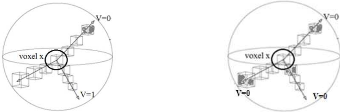
Figure 3—7: OA géométrique basée Ray-casting pour les données volumiques: Visibilité tout-ou-rien. (Gauche) x est partiellement visible. (Droite) x est complètement invisible.
