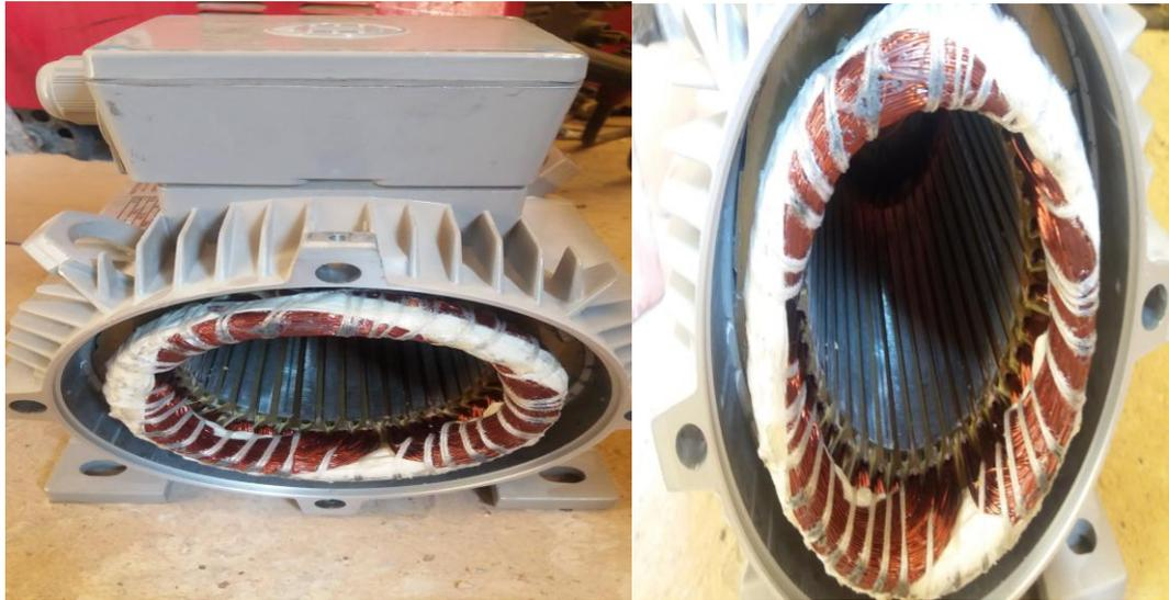
**Figure 1.** Photo de la disposition des enroulements sur les encoches statoriques.
