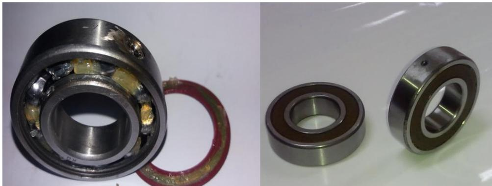
**Figure III.11.** Photos d'un roulement défectueux dans la BE.
