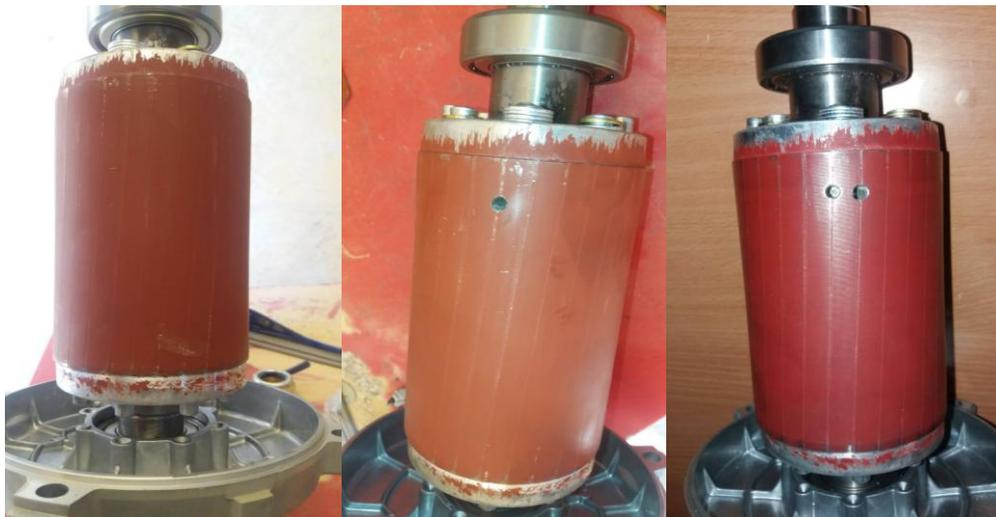
**Figure II.4.** Photographie des rotors de la MAS de 3 kW pour un état sain (à gauche), une barre cassée (au centre), deux barres cassées (à droite).
