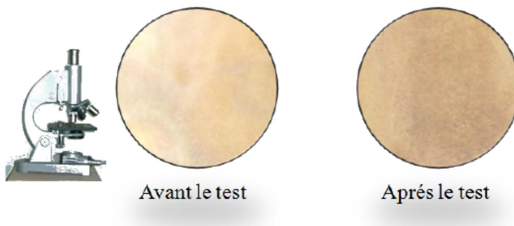
**Figure III.2:** Micrographies en microscopie optique du ((tape test)) sur une couche mince de ZnO.
