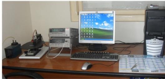
**Figure .9:** dispositif quatre pointes, modèle JANDEL RM 3000.
