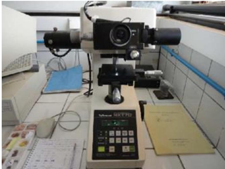
**Figure II.7:**Microduromètre Matsuzawa MXT 70.
