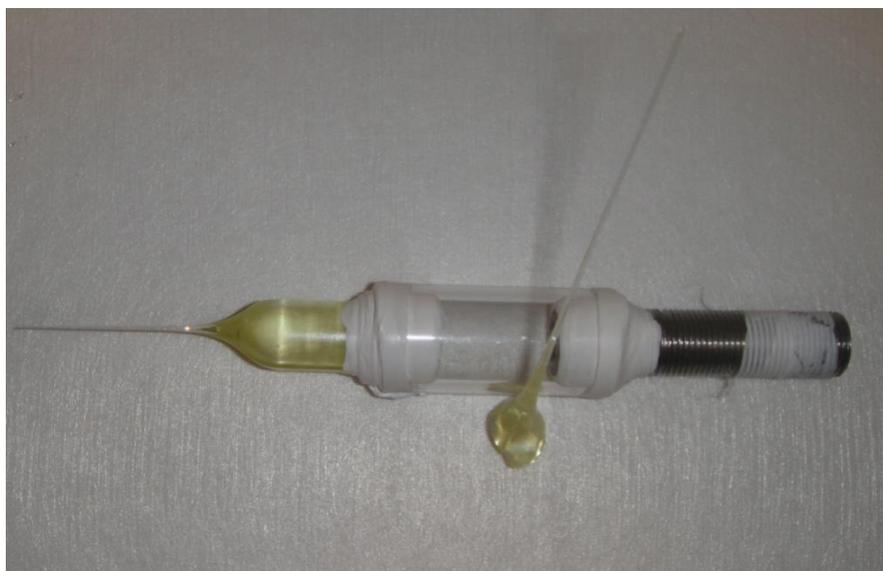
**Figure V.10 :** Cône et goutte de fibrage du barreau du verre  $80\text{Sb}_2\text{O}_3\text{-}10\text{K}_2\text{O-}10\text{PbO}$ .
