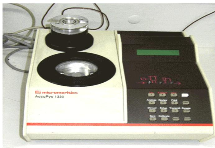
**Figure II.5 :** Pycnomètre à hélium modèle ACCUPYC 1330 MICROMERITICS.
