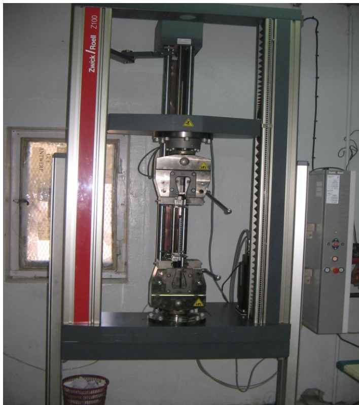
Figure III.4. Photographie de la machine de traction utilisée (Zwick Roell Z 100)
