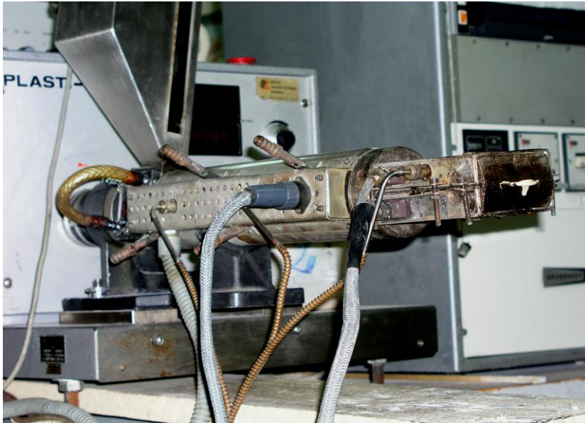
Figure III.3. Photographie de l'extrudeuse utilisée (SCHWABENTHAN PLE 330).
