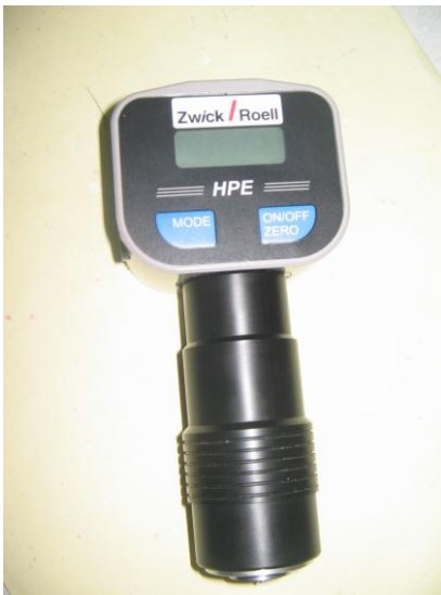
Figure III.7. Photographie du duromètre utilisé (HPE Zwick-Roell)
