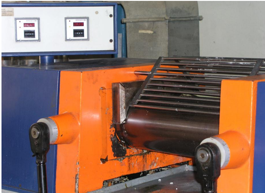
Figure III.2. Photographie de la calandreuse utilisée (BRABENDER polymix 200P)
