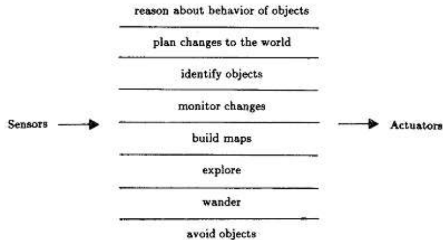
Figure 1.4 : Décomposition du contrôle d'un robot mobile en comportements
