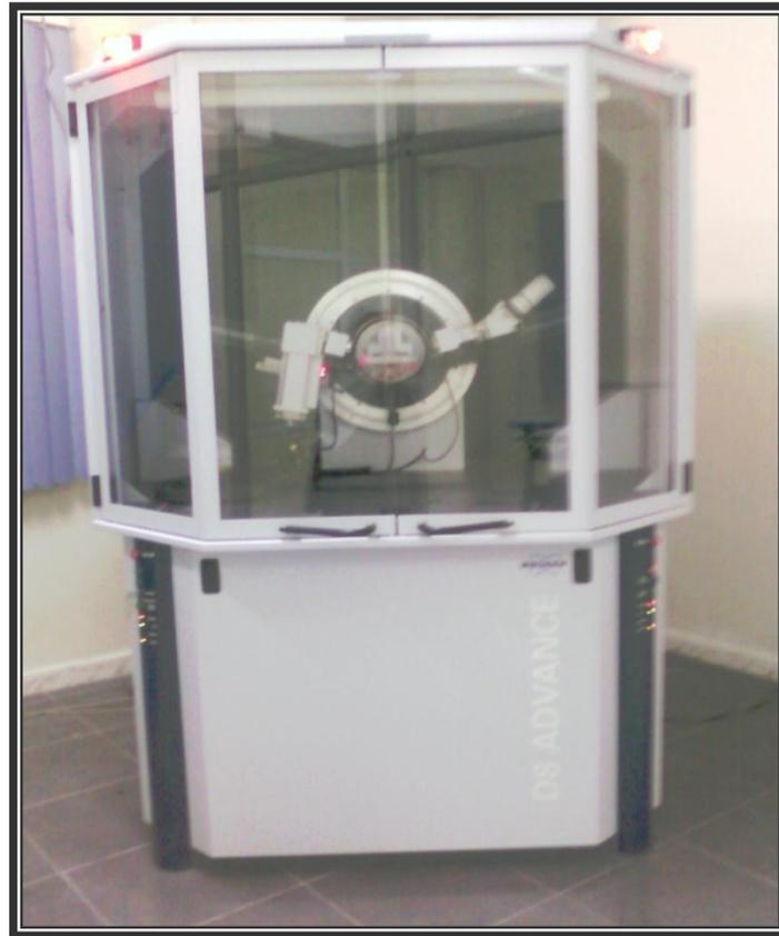
**Figure.3.5: Diffractomètre de RX**
