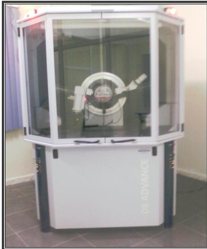
Figure.III.7: Diffractomètre de RX
