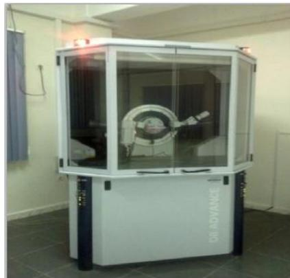
**Figure III.16:** Diffractomètre du type BRUKER-AXS type D8.
