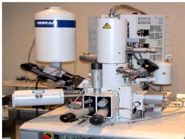
Fig. III.19: JEOL, model JSM 6360LV microscope électronique à balayage à effet de champ.
