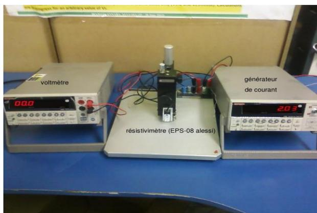
**Figure III.25:** Photographie du dispositif de mesure 4 pointes
