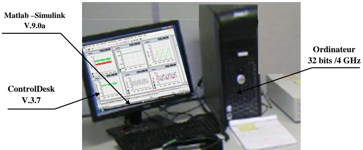
Figure II.19 : Photo de la partie Interface Homme Machine.
