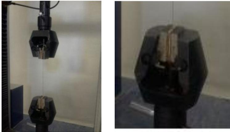
**Figure 3.18** : Technique pour éviter le glissement de la fibre végétale
