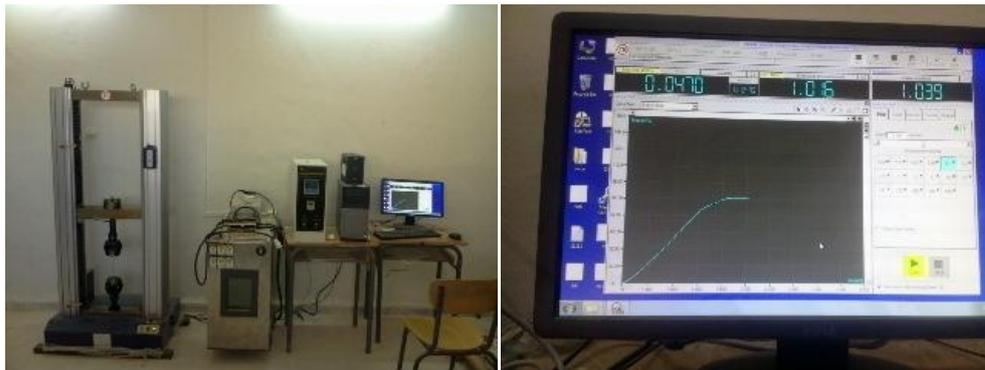
**Figure 3.17 :** Machine de traction électromécanique universelle WDW
