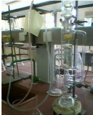
**Figure 3.5 :** appareil de soxhlet pour l'extraction
