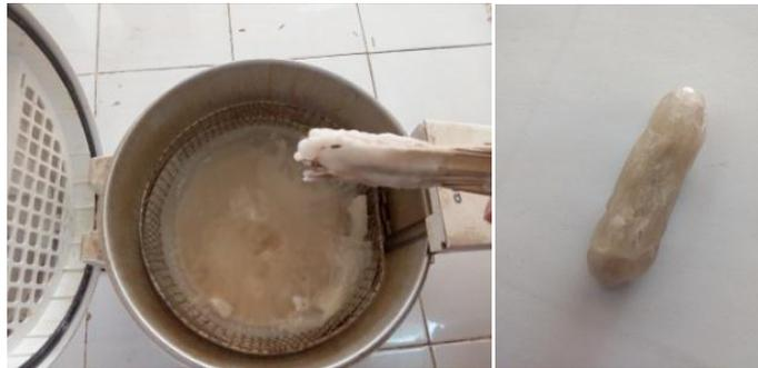
**Figure 3.13 :** Immersion de l'échantillon dans la paraffine
