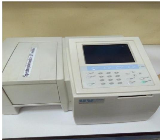
**Figure 3.9 :** Spectrophotomètre UV / Visible
