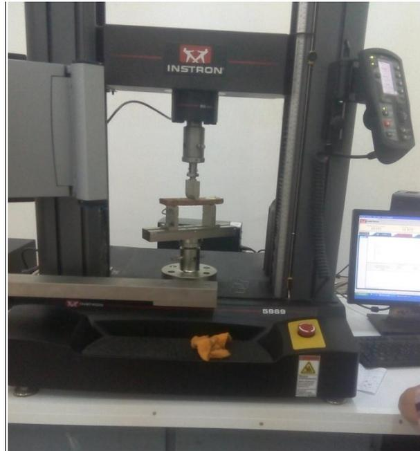
**Figure 3.21** : Machine d'essais mécanique de flexion trois points
