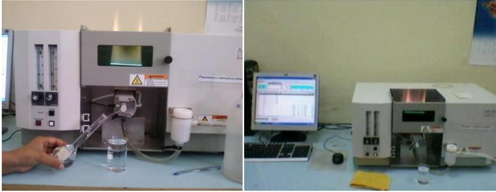
**Figure 3.7 :** Appareil d'absorption atomique
