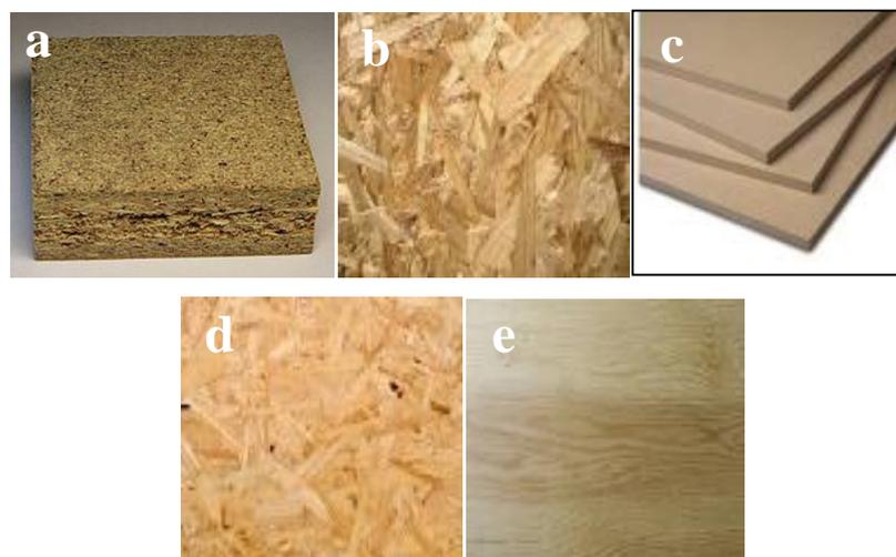
**Figure 1.9** : panneaux de bois : (a) panneaux de particules, (b) panneaux de copeaux, (c) panneaux MDF, (d) panneaux OSB, (e) contreplaqué
