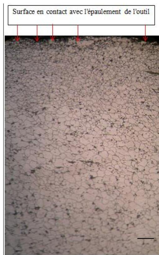
Figure IV. 6: Microstructure optique de la surface en contact avec l'épaulement de l'outil de soudage.
