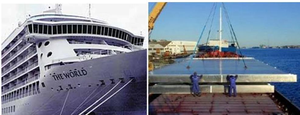
Figure II. 6 : a ) Bateau en aluminium construit en utilisant FSW, (b)-Panneaux préfabriqués ( Hydro Marine Aluminium ) destinés au pont du bateau de croisière [10].
