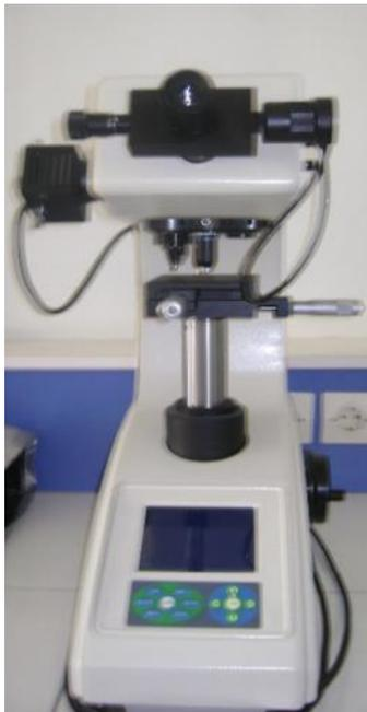
Figure III. 18: microduromètre Vickers.
