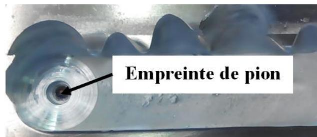
Figure II. 10: Trou à la fin de soudure.
