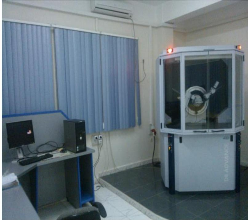
Figure III. 16: Diffractomètre de rayon X de type Bruker D8 advance.
