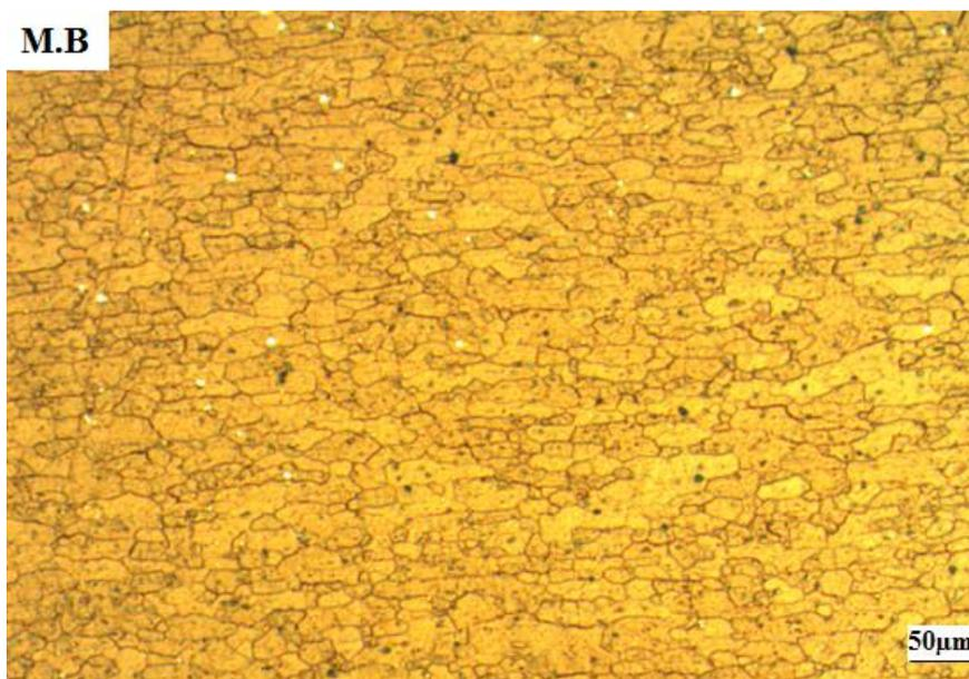
Figure IV. 4: Microstructure d'Al-6061-T6 avant le soudage.
