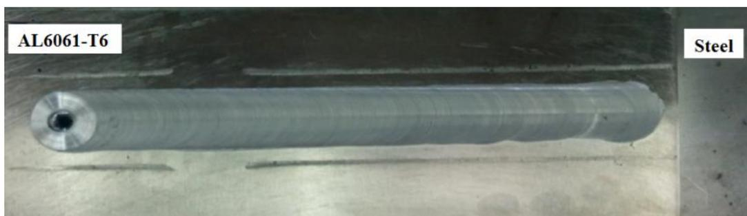
Figure IV. 42 : Vue macroscopique d'un joint soudé par friction malaxage.
