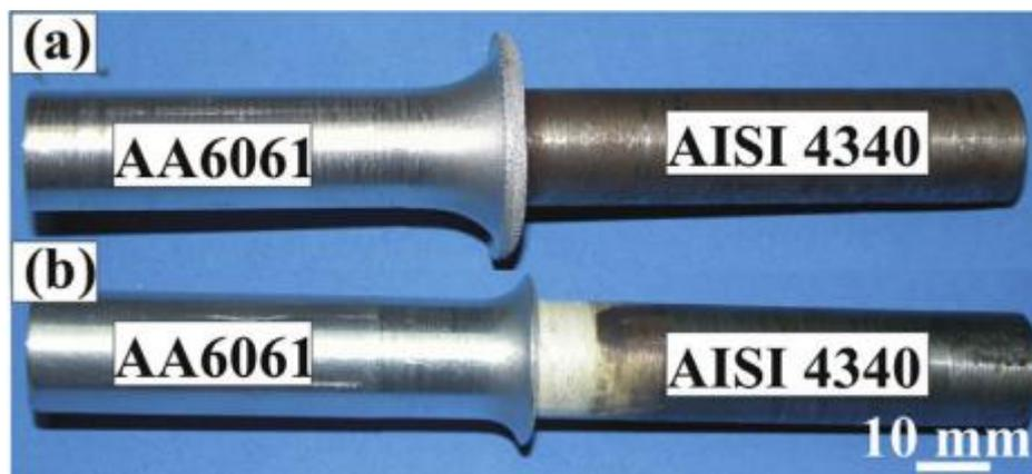
Figure I. 17: Macrographie de soudage par friction AA6061-AISI 4340 [47].
