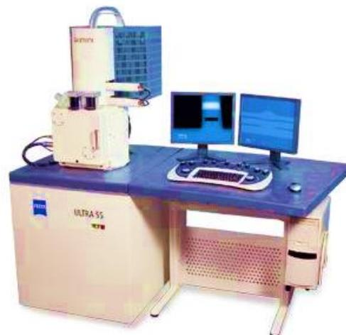
Figure III. 15: Microscopie électronique à balayage de type Zeiss.
