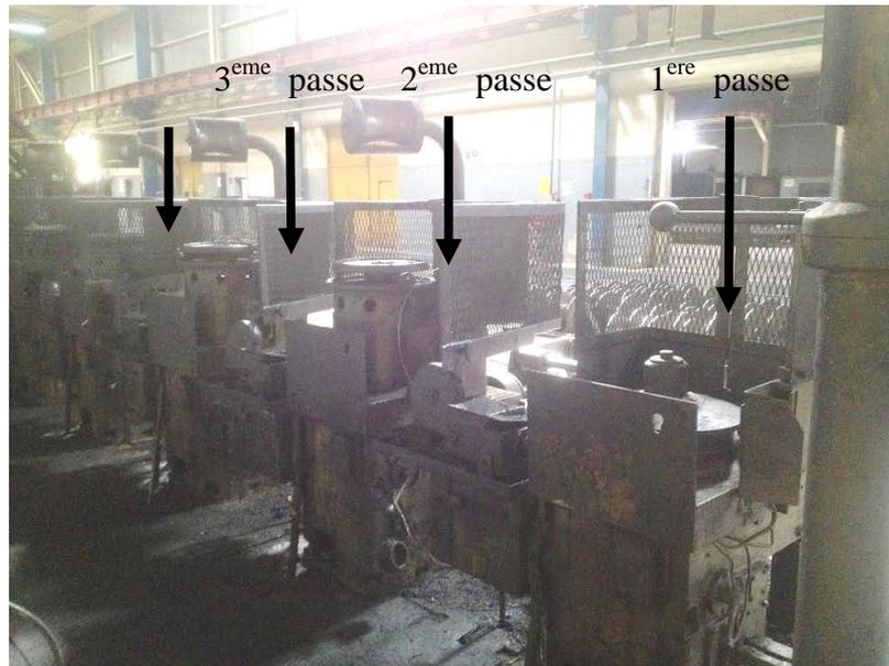
Figure 3.1 : Différentes passes au niveau de la machine d'aluminium AGS(ENICAB Biskra).
