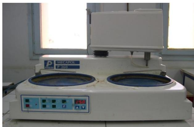
*Figure 3.5: Polisseuse mécanique de type PRESI MECAPOL P260 (Laboratoire de physique, univ -Biskra).*
