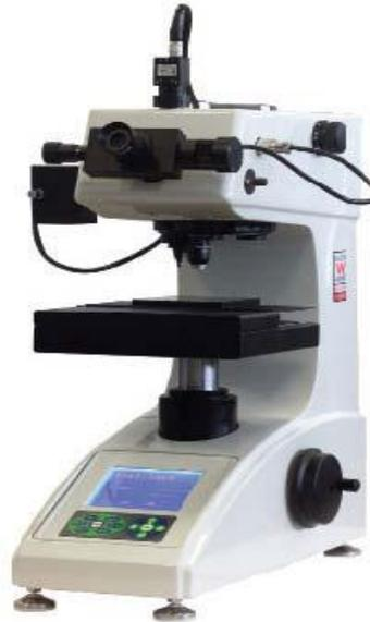
*Figure 3.8: Microduremètre Vickers (Laboratoire de physique, univ -Biskra).*
