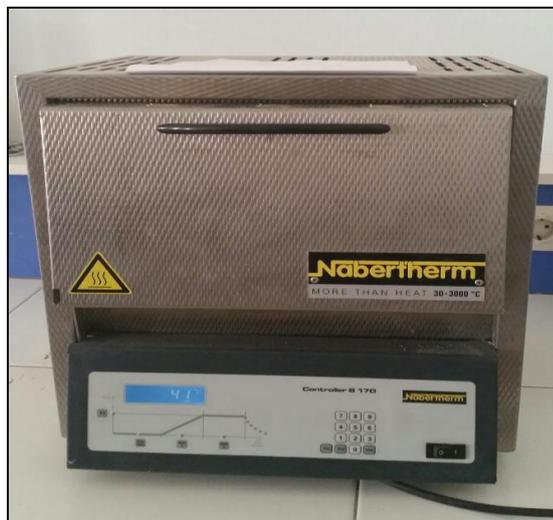
*Figure 3.3 : Four programmable pour traitement thermique (Laboratoire de physique, univ -Biskra).*
