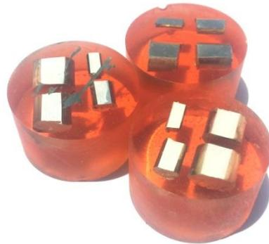
*Figure 3.4 : Echantillons coupés et enrobés.*
