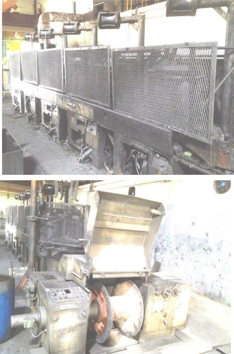
*Figure 1.9 : Machine de tréfileuses d'aluminium AGS (ENICAB Biskra).*
