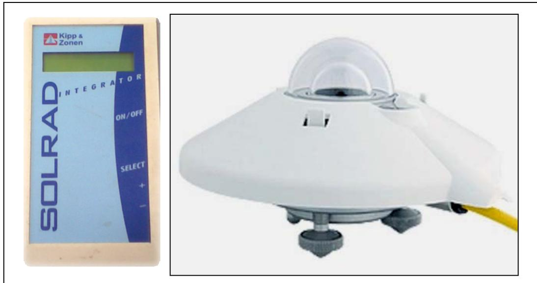
Photo 4 : Pyranomètre Kipp et Zonen
