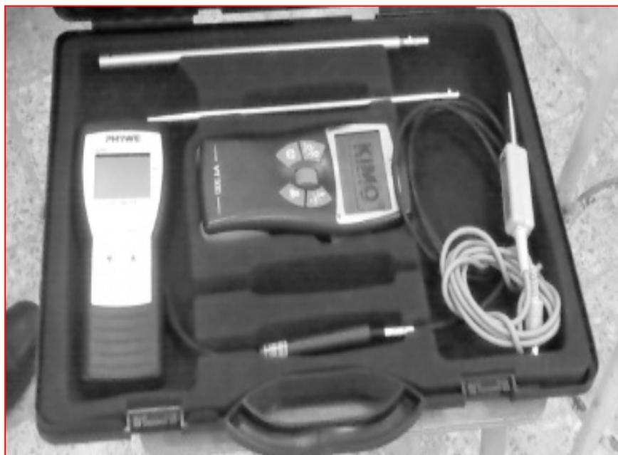
Photo 5 : Anémomètre à fil chaud
