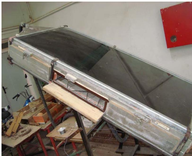
**PHOTO 2 :** Dispositif expérimental II (séchoir à simple passage d'air).
