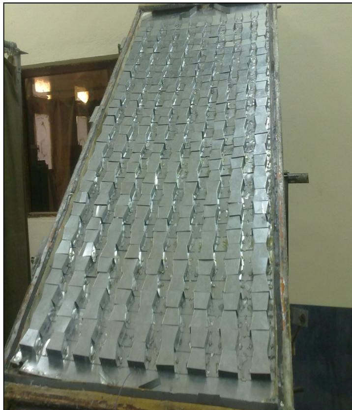
Photo 2 : Présentation des chicane du capteur (B)
