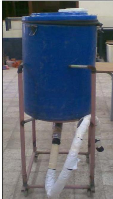
**Photo. 3 :** Chambre de séchage (séchoir à simple passage d'air).
