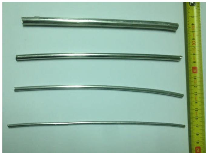
**Figure III.2: Le fil machine et les trois fils déformés choisis.**
