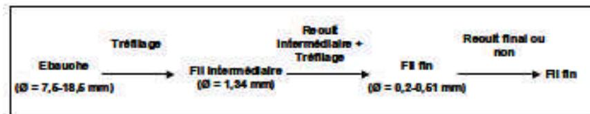
Figure I.1: Procédé de mise en forme et recuit des fils d'aluminium.
