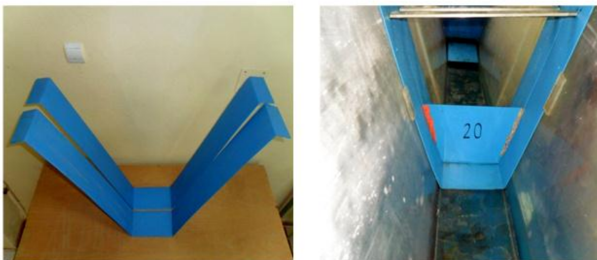
Figure 1.9 : Photographie de support du seuil.
