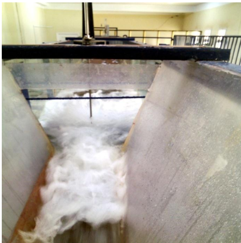
Figure 2.2 : Photographie du canal de mesure de section trapézoïdal brusquement élargi à un canal rectangulaire.
