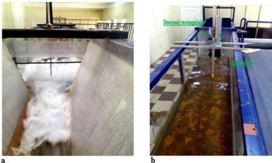
Figure 2.5 : Photographies du canal trapézoïdal brusquement élargi. (a) Élargissement brusque trapèze-rectangle. (b) Déversoir rectangulaire pour la mesure du débit.
