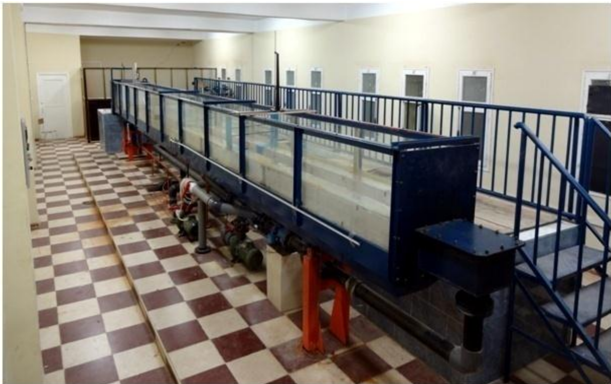
Figure 3.2 : Photographie du canal de mesure de section rectangulaire composé.
