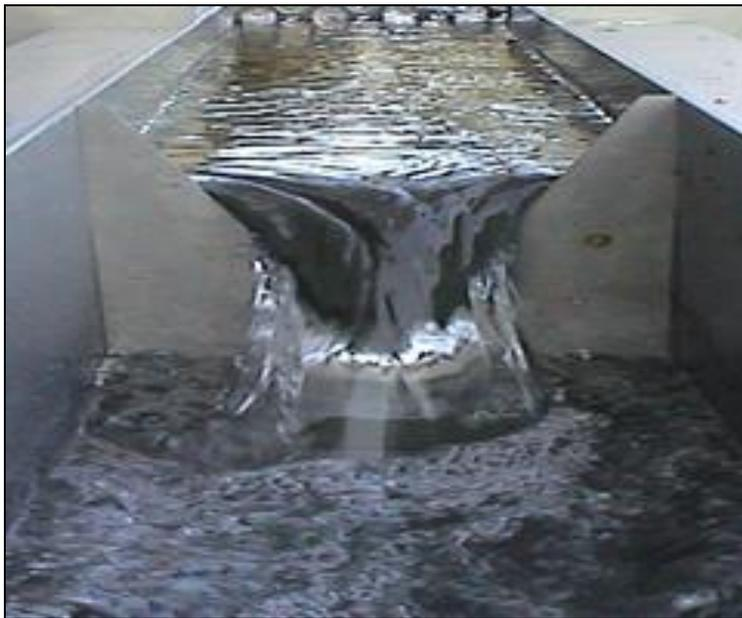
Figure I-06: Déversoir en mince paroi à échancrure triangulaire - France (E.A.U.R.M.C)
