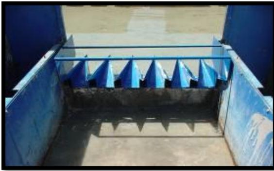
Figure V-29 : Forme en plan triangulaire
