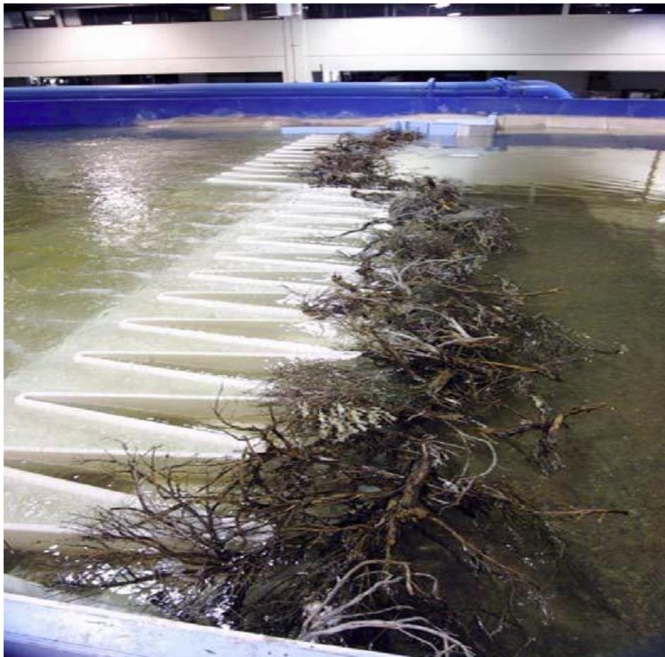
**Figure III-30 : Essai sur l'effet des corps flottants (TULLIS et al, 2011)**
