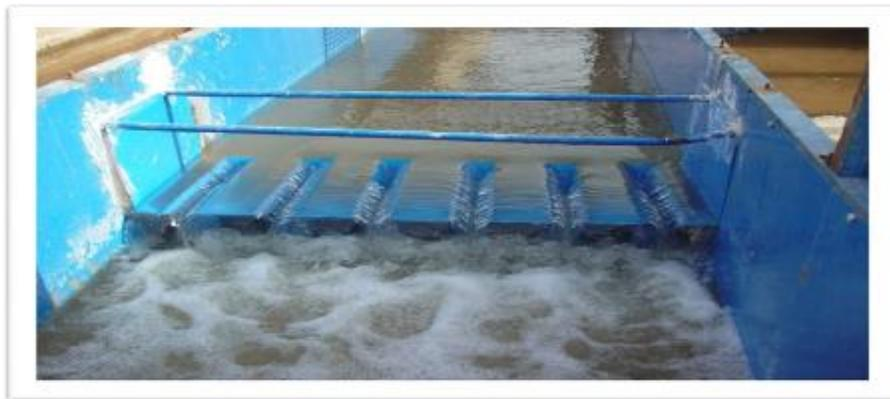
**Figure III-05 : Écoulement en deux nappes déversantes sur déversoir en labyrinthe développé**
