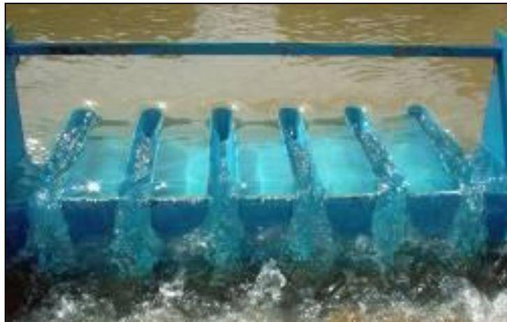
**Figure I-26 : Ecoulement à faible charge (BENSAID et al – Magister 2008)**
