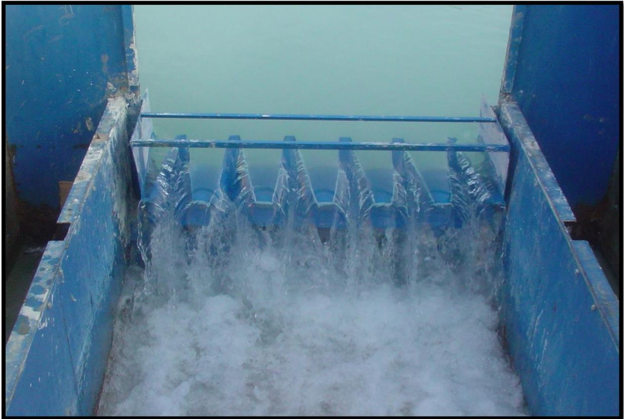
**Figure 11 : Ecoulement sur le déversoir en labyrinthe développé trapézoïdale**
