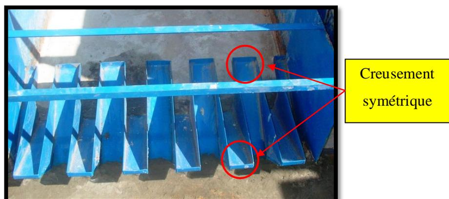
Figure V-15 : Déversoir avec creusement symétrique (modèle D03)
