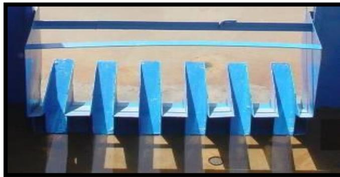
**Figure V-27 : Déversoir en labyrinthe développé (modèle D11)**
