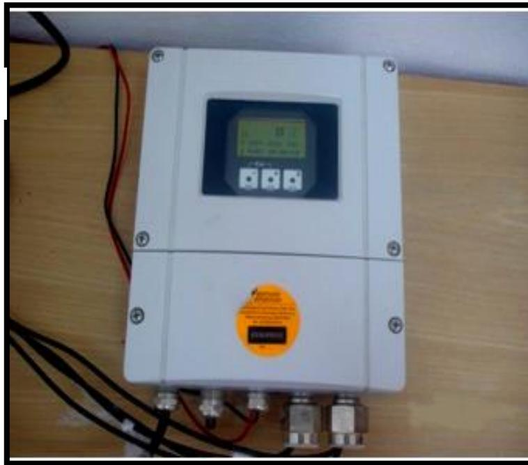
**Figure V-10 : Débitmètre ultrason (Prosonic Flow)**
