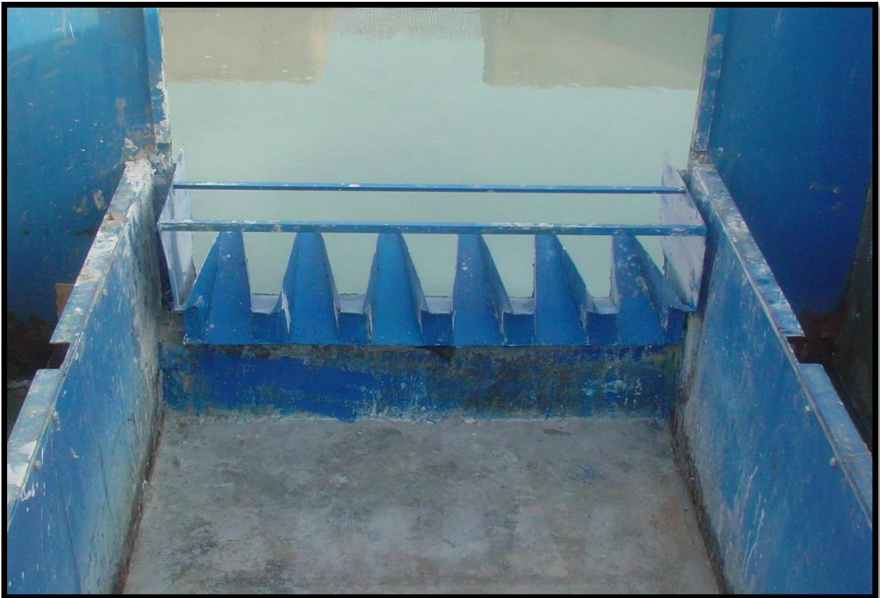
**Figure 10 : Forme en plan du déversoir en labyrinthe développé trapézoïdale**
