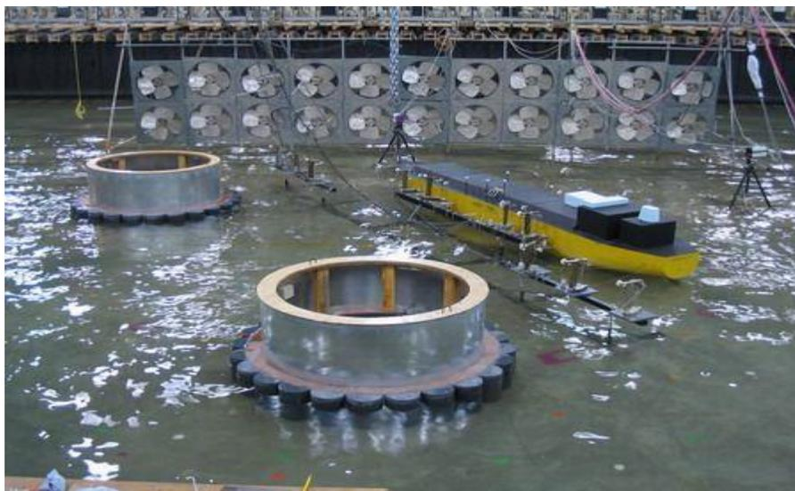
**Figure IV-01: Modèle physique employé pour simuler les conditions environnementales d'un terminal méthanier (source : Conseil national de recherches du Canada)**
