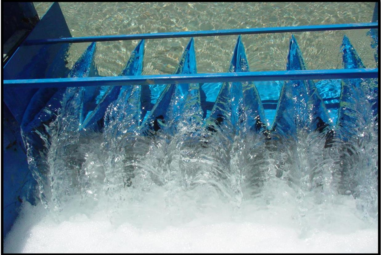
**Figure 09: Ecoulement sur le déversoir en labyrinthe développé triangulaire**
