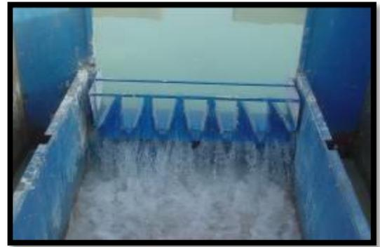
Figure V-30 : Forme en plan trapézoïdale
