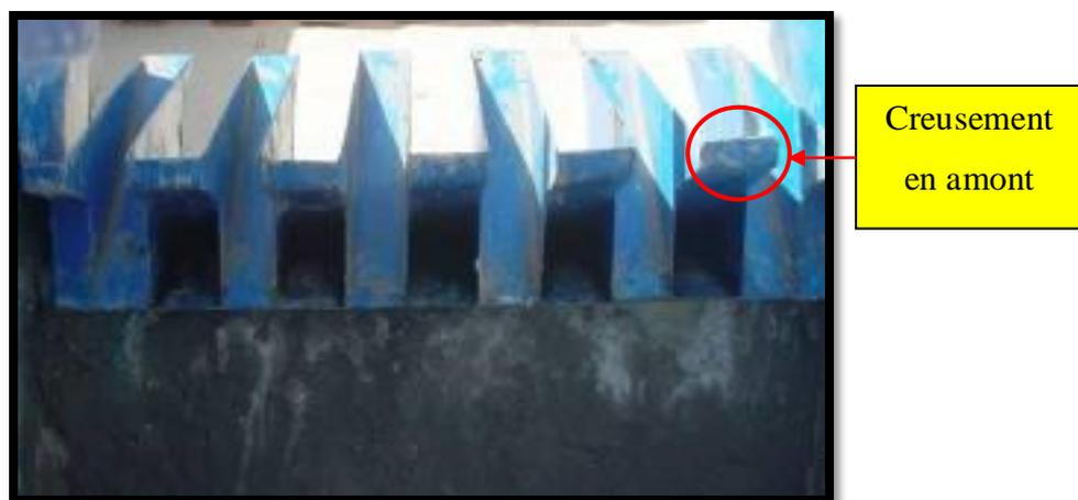
**Figure V-19 : Déversoir creusé uniquement en amont (modèle D04)**
