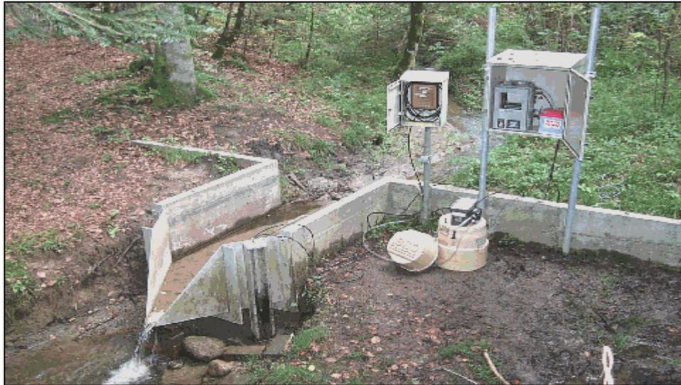
Figure I-01 : Essai de mesure de débit par un déversoir – France (E.A.U.R.M.C)
