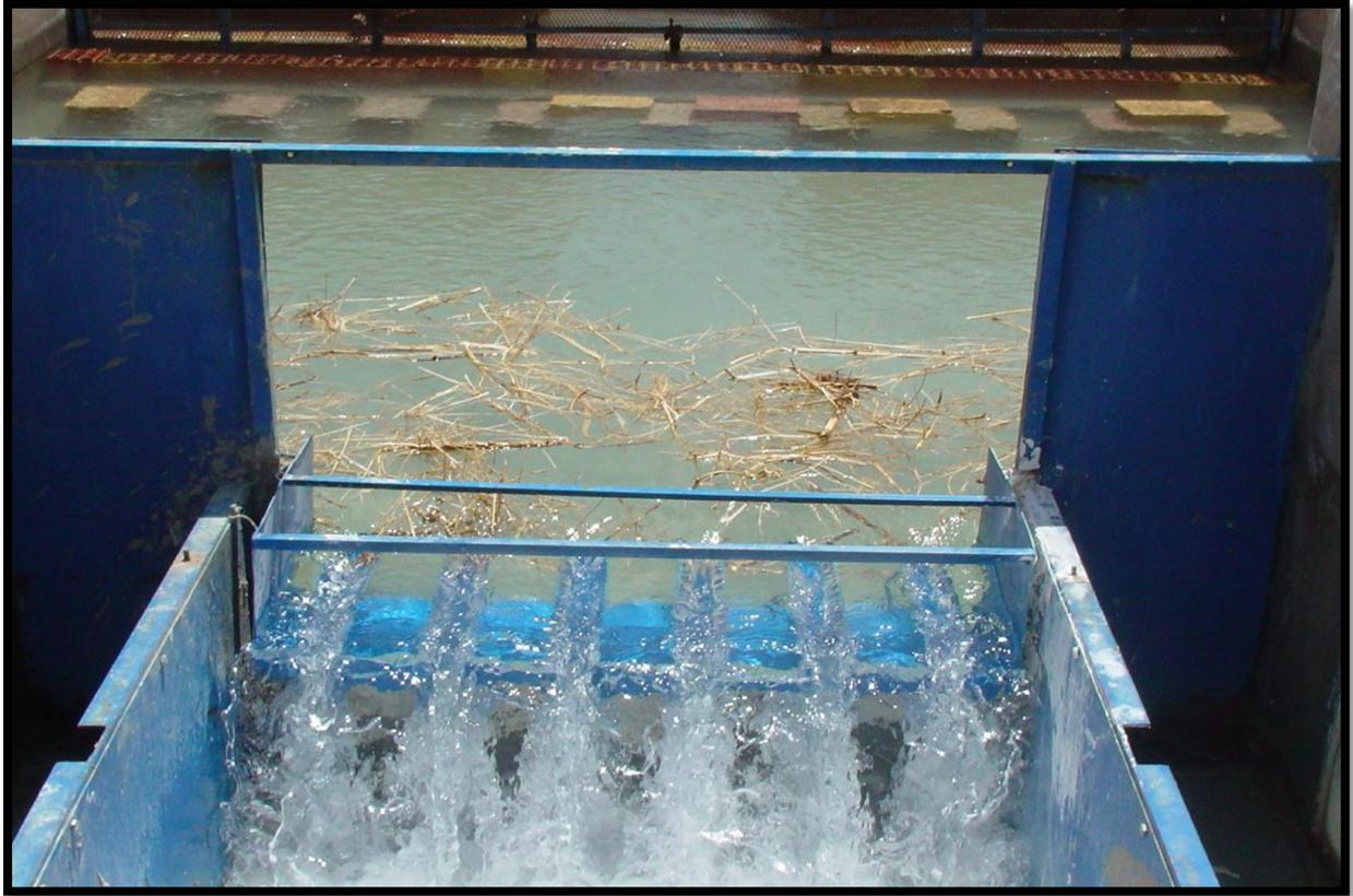
**Figure 07: Présence des corps flottants sur le déversoir non rectiligne creusé**
