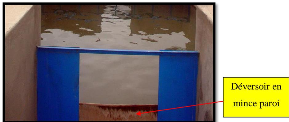
Figure V-14 : Déversoir en mince paroi (modèle D01)
