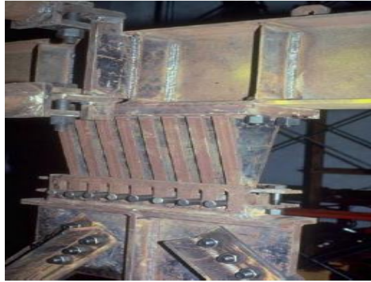
Figure 3.6 Détails de connexion du dispositif-à-contrevent TADAS[105].
