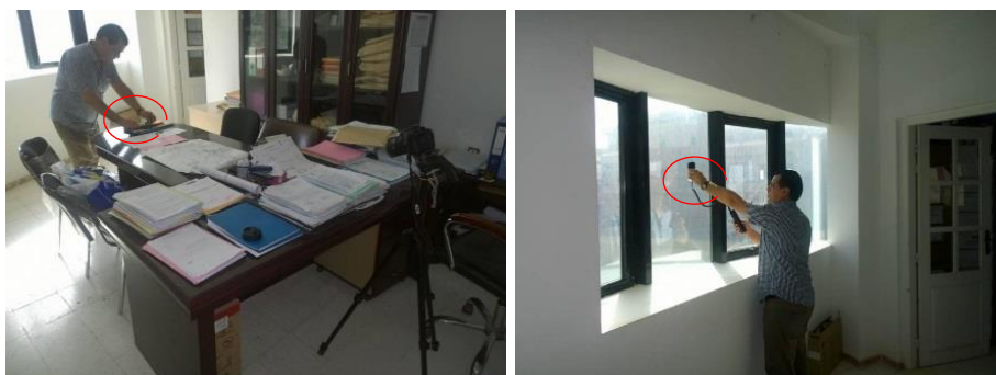
Figure V.30 : prise de mesure du niveau de l'éclairement sur le plan de travail, et sur le centre de la fenêtre de bureau (Source : Auteur).
