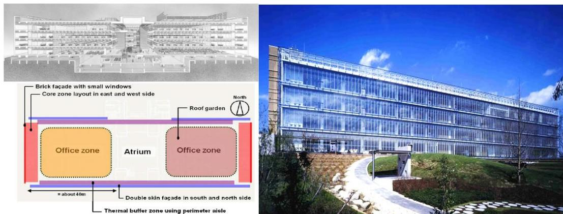
**Figure 1.25 :** Exemples d'un immeuble de bureaux réalisé à travers l'application des stratégies de l'architecture bioclimatique (Source : Heiselberg, 2009)
