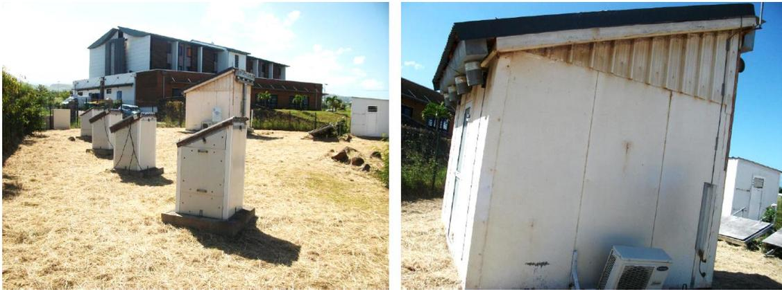
**Figure 4.4 :** Étude expérimentale de l'impact des matériaux à changement de phase
