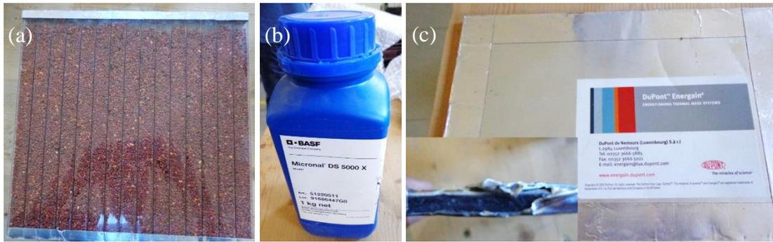
**Figure 2.27** : Exemples des matériaux à changement de phase (Source : Auteur, 2017)
