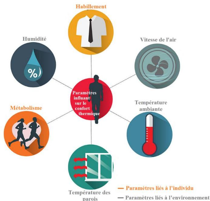
**Figure 3.1 :** Les paramètres influant sur le confort thermique
