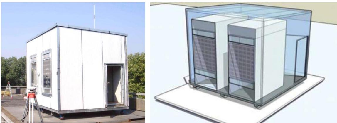
**Figure 4.30** : Étude expérimentale et numérique sur l'intégration des capteurs photovoltaïques semi-transparents dans le vitrage (Source : Xu, 2014)
