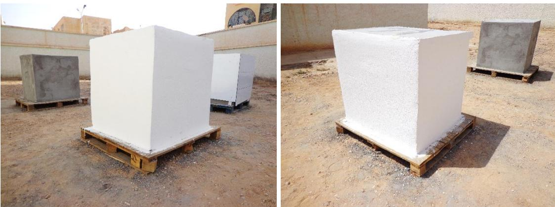
**Figure E.4 :** La cellule (C2) avec une peinture isolante (Source : Auteur, 2017)
