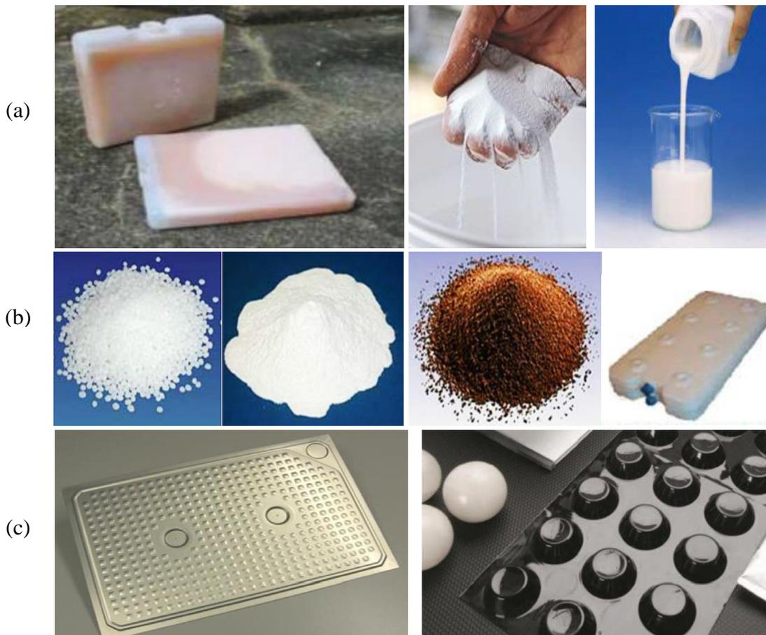
**Figure 2.28** : Les formes des matériaux à changement de phase
