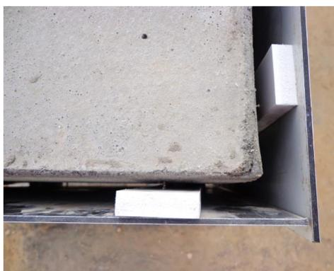
**Figure 6.12** : La cavité d'air de la cellule "C3" (Source : Auteur, 2017)
