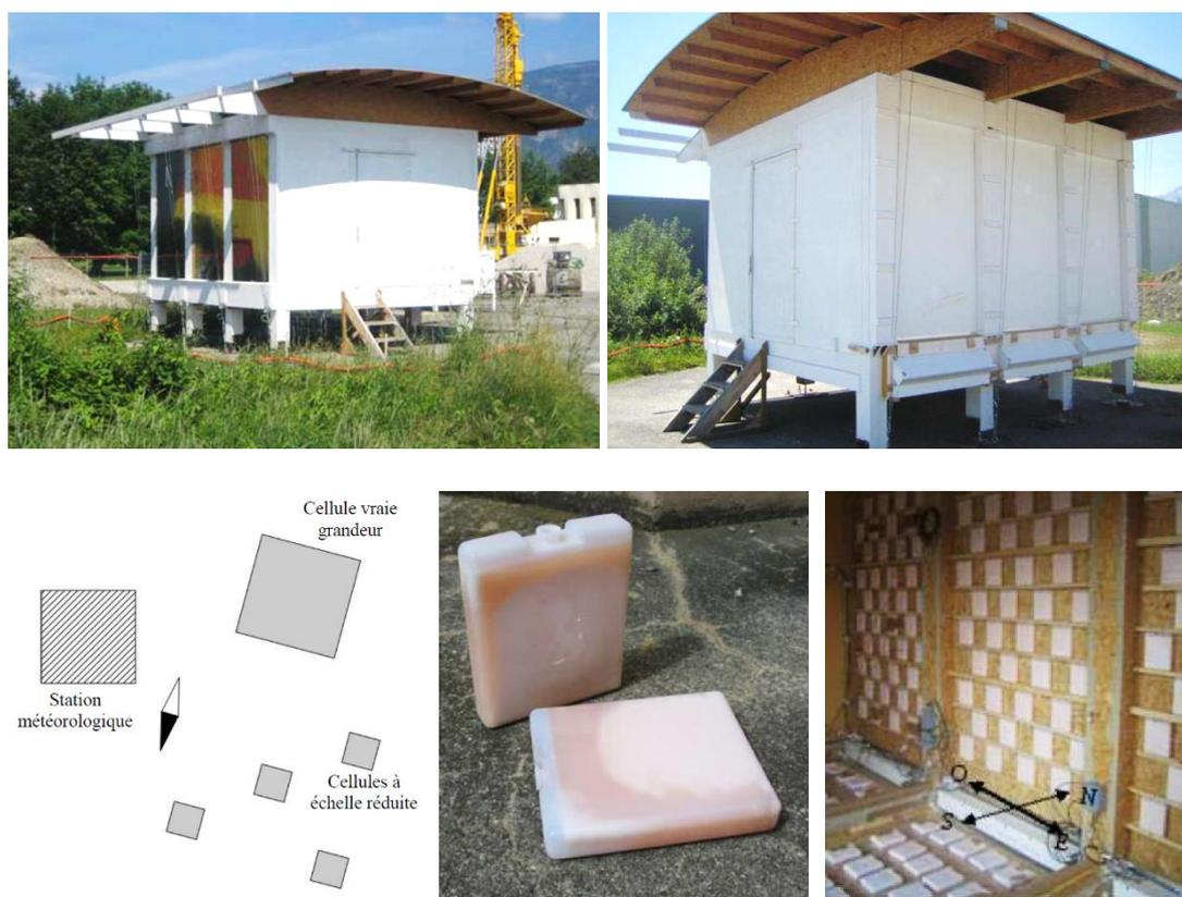
**Figure 4.2 :** Étude expérimentale sur l'optimisation de l'enveloppe par l'intégration des matériaux à changement de phase (Source : Faure, 2007)
