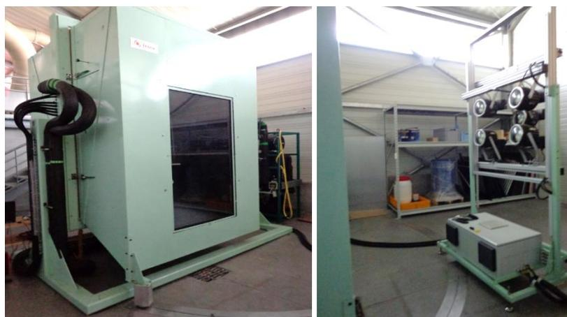
**Figure 4.40** : Appareil de mesure du facteur solaire des éléments translucides de l'enveloppe du bâtiment (Source : Auteur, 2017)
