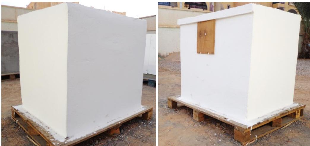
**Figure 6.7 :** La cellule "C2" avec une peinture isolante (Source : Auteur, 2017)
