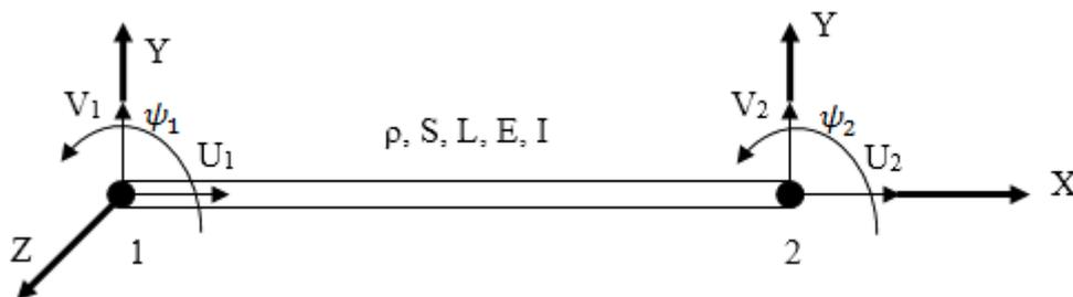
FIG-3. 1. Élément poutre en flexion à six degrés de liberté.
