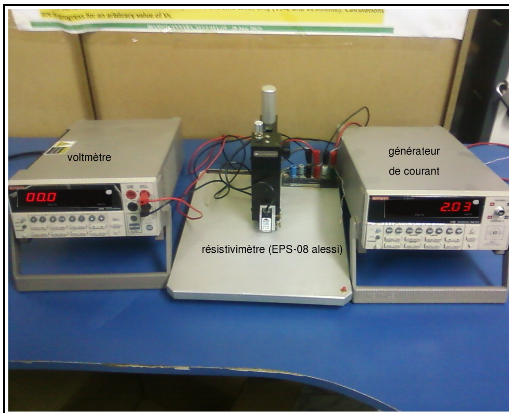
FIGURE 3.12 – Montage expérimental de la technique des quatre points
