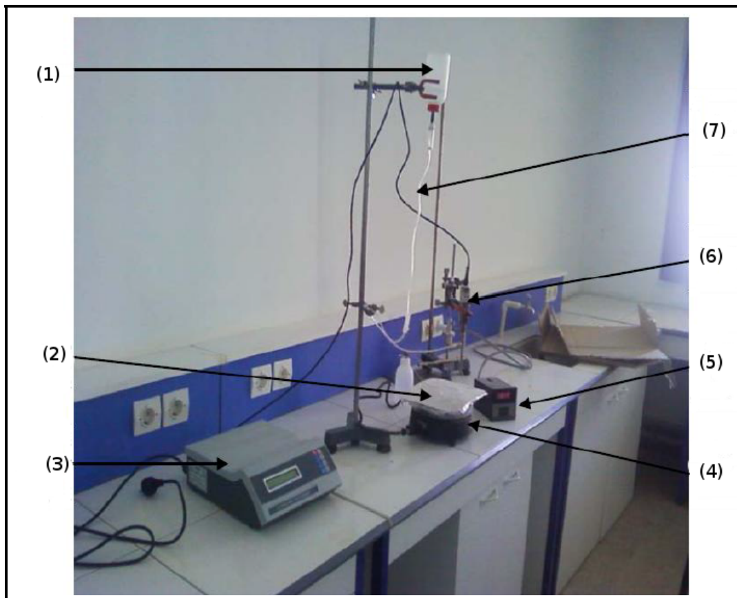
FIGURE 3.13 – Dispositif expérimental de la technique Spray Ultrasonique
