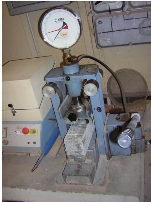
Photo II.4: Essai de flexion sur prisme (10x10x40) cm
