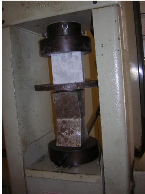
**Photo II.3:** Essai de compression sur cube de (10x10x10) cm
