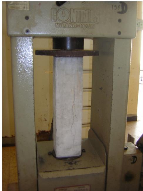
**Photo II.7:** Essai de déformabilité : compression sur prisme de 10x10x40 cm
