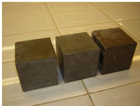
**Photo II.6:** Essai d'absorption sur cubes de 10x10x10 cm
