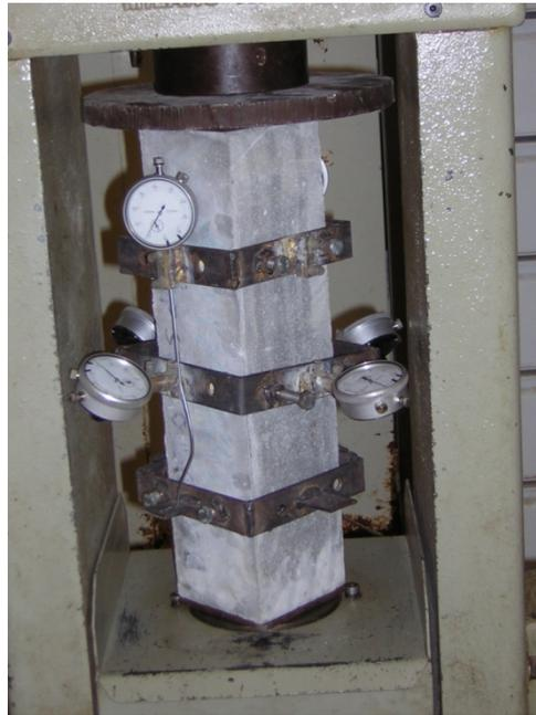
**Photo II.8:** Essai de déformabilité : mesure des déformations pendant la compression du prisme de 10x10x40 cm
