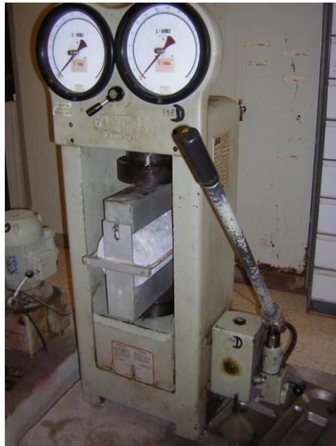
Photo II.5: Essai de traction par fendage sur cylindre (16x32) cm
