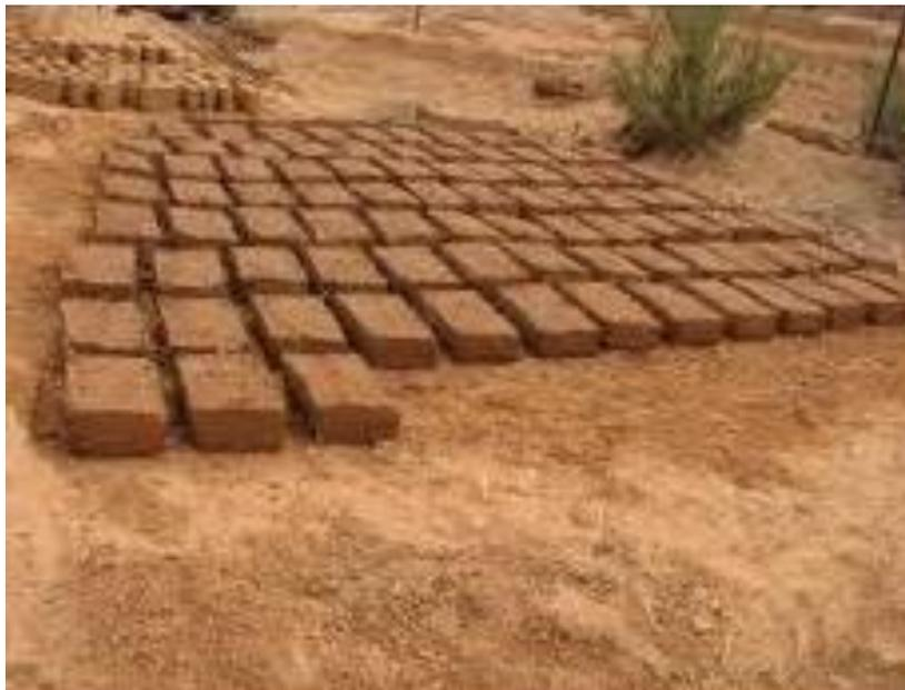
**Photo N30 : Séchage des briques de terre en plein air -source auteur-**
