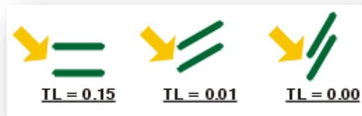
Figure 08 : Transmission lumineuse à travers les lames du store vénitien.
