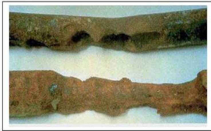
**Figure I.7 :** Pique profonde causée par une attaque de chlorure. [51].
