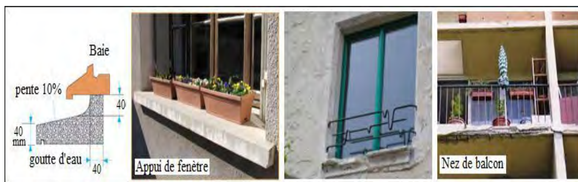
Fig. V.6 : Détail de l'appui de fenêtre. Source : AQC, 2011.
