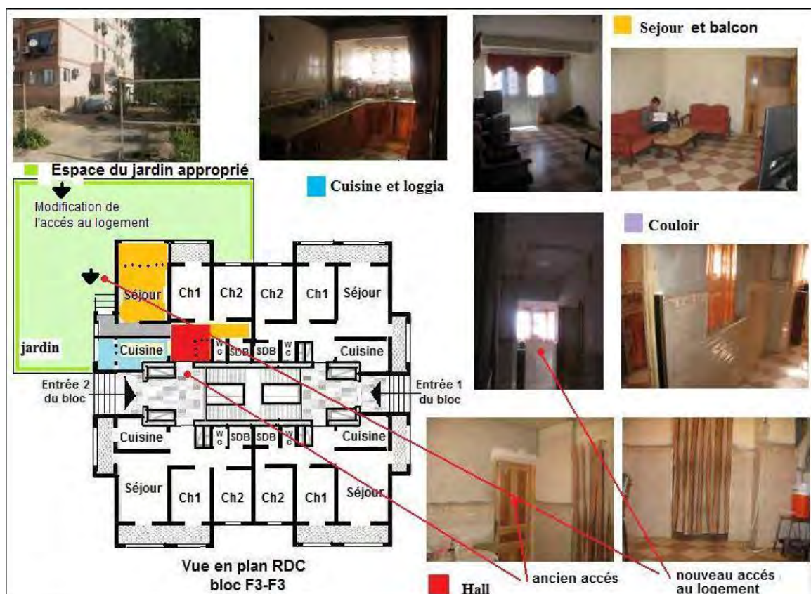
Fig. X.27 : Logement modifié affectant les gros-œuvre et les second-œuvre, copropriété 1000 logements.
