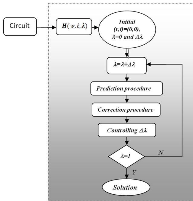
**Fig. IV.4.** Algorithm OP analyses.
