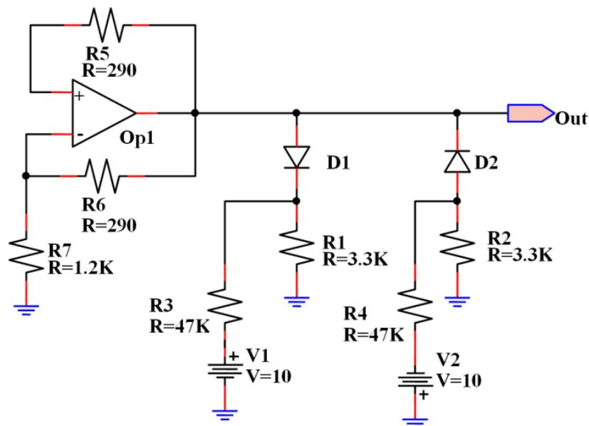
Fig. IV.29. Diode Chua circuit.
