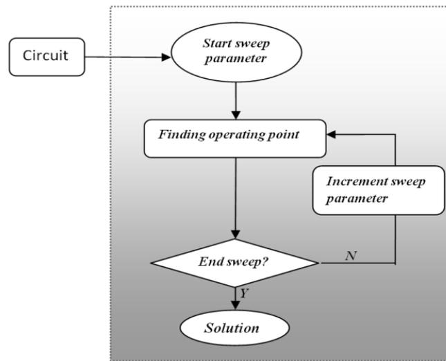
**Fig. IV.5.** Algorithm DC analyses.
