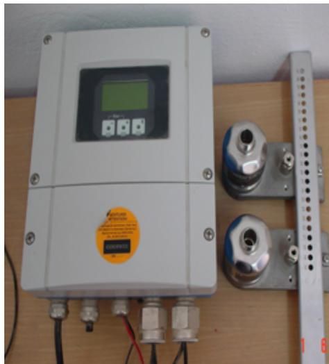
*Figure III.04. Débitmètre à ultrason Flowmeter 93W2.*
