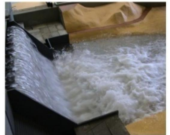
Figure I.72. Modèle réduit du déversoir en touches de piano PK-Weir - Barrage Ouldjet Mellegue –Algérie ([www.pk-weirs.ulg.ac.be](http://www.pk-weirs.ulg.ac.be)).
