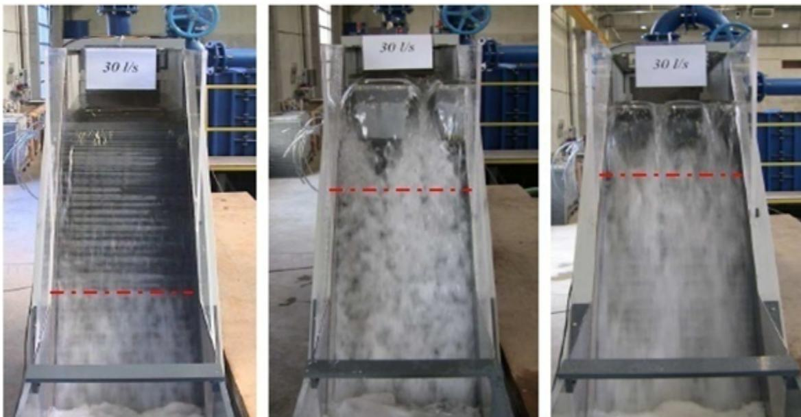
Figure I.58. Comparaison de la position du point de début d'eau blanche (chenal aval dans sa position I, pour  $Q = 30 \text{ l/s}$ ) - gauche : seuil libre standard, centre : PK-Weir1 et droite : PK-Weir2 (Ercicum et al., 2011).
