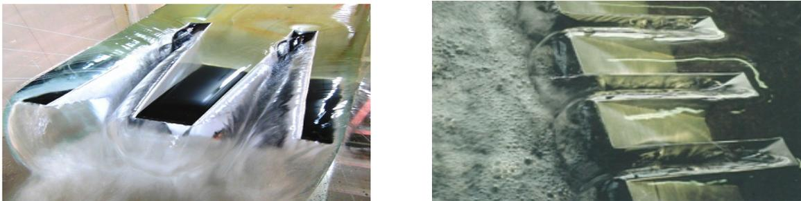
Figure I.38. Différents types de PK-Weir a) trapézoïdale, b) rectangulaire (Cicéro et al., 2013b).
