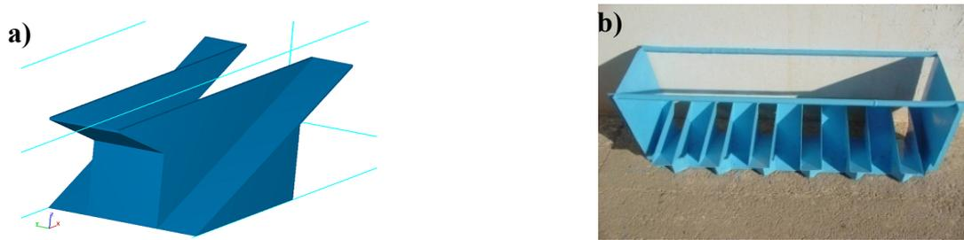
Figure I.68. a) Vue en 3D du PK-Weir, b) Modèle physique du PK-Weir (Athmani et al. 2014a).
