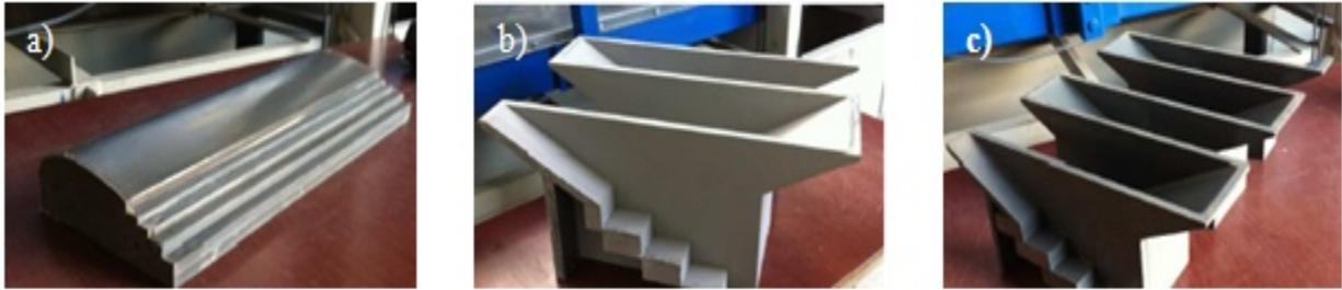
Figure I.57. a)- déversoir libre standard, b)- déversoirs PK-Weir1, c)- déversoirs PK-Weir2 (Ercicum et al., 2011).
