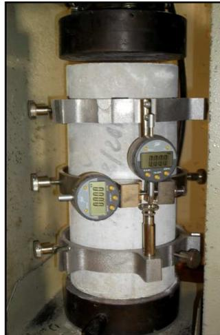
**Figure III.16** Mesure de déformabilité par la cage extensométrique
