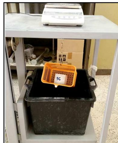
**Figure III.19** La pesée hydrostatique
