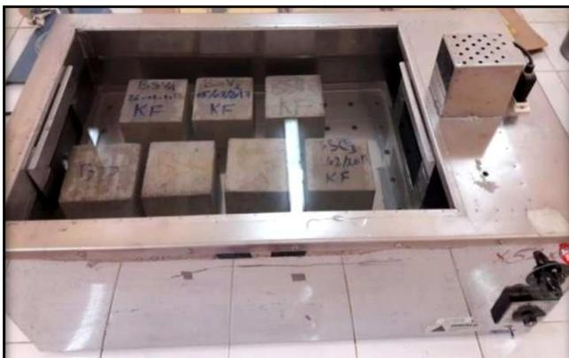
**Figure III.18** Bain marie pour l'ébullition des éprouvettes
