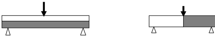
a) superposition des deux couches de bétons
