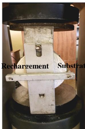
a. Eprouvette composite cylindrique
