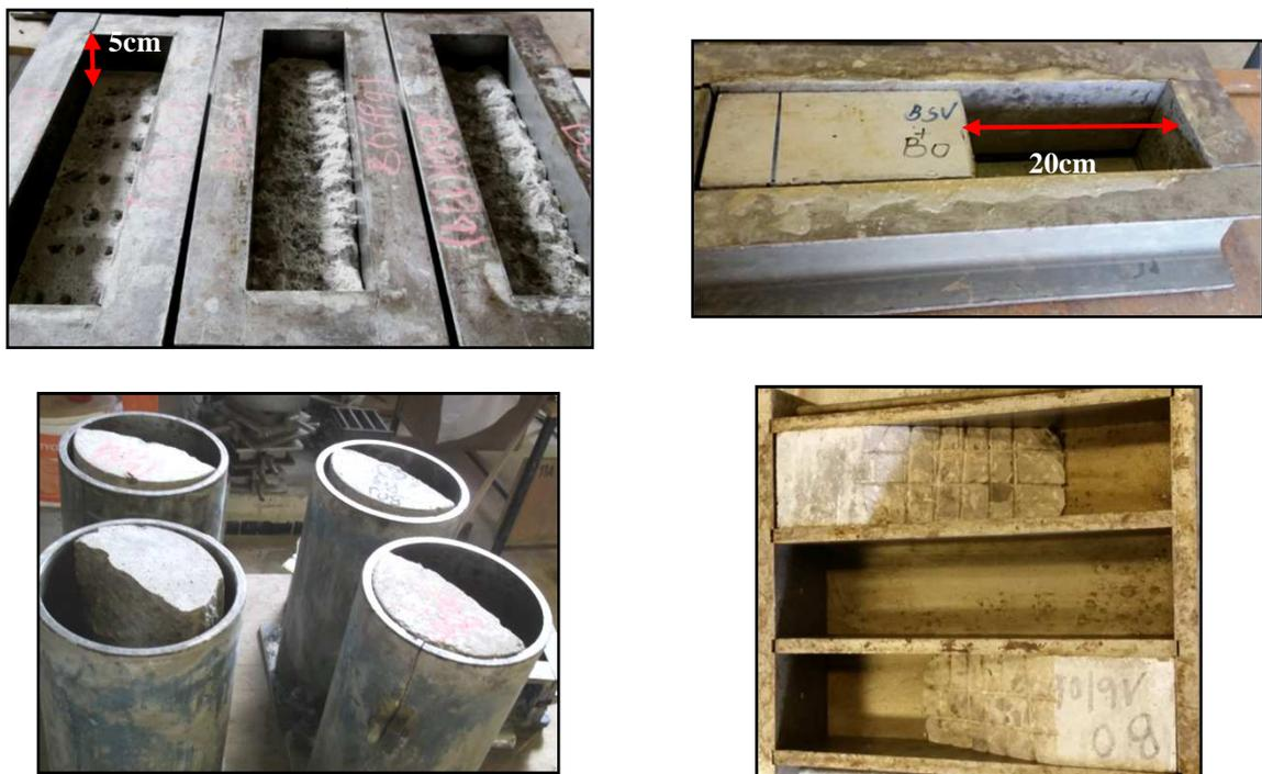
**Figure II.3** La mise en place des substrats dans les moules avant l'application du rechargement
