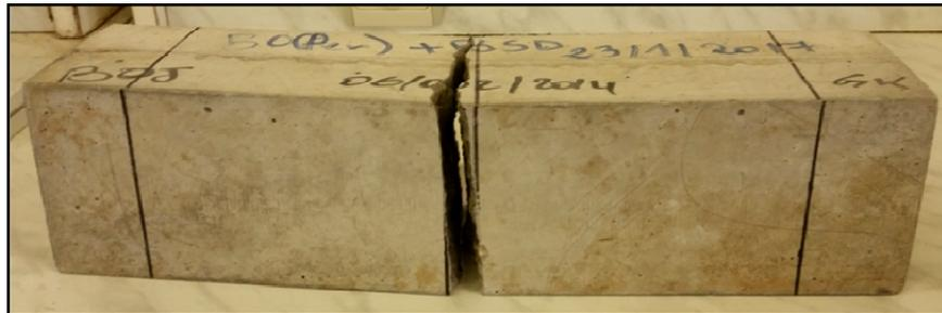
**Figure IV.2.** Mode de rupture des éprouvettes composites soumises à la flexion (Cas A)
