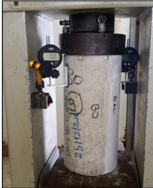
**Figure II.11** Dispositif de mesure des variations dimensionnelles des composites
